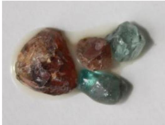
Figura nº 6.- Detalle de las coloraciones y la fractura características del circón
