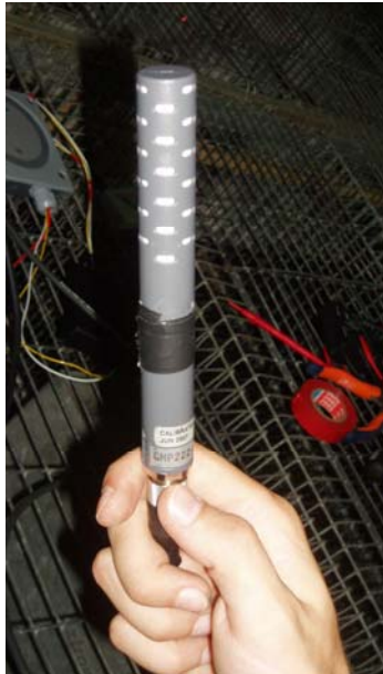
Figura A-1. Sensor de dióxido de carbono CARBOCAP®
