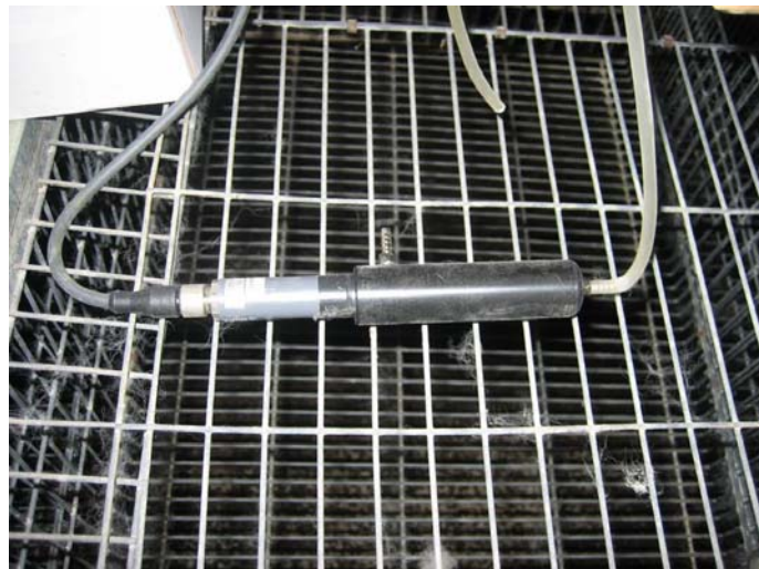
Figura 41. Detalle de la colocación del sensor de dióxido de carbono
