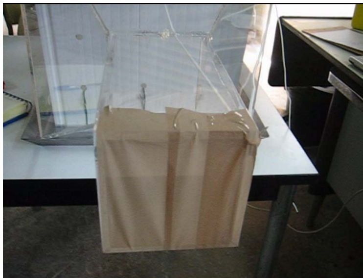
Figura 31. Detalle del sellado de la cámara
