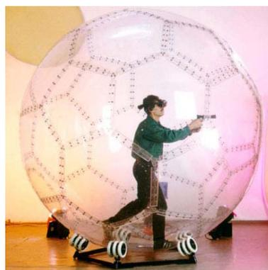
Figura 15: Simulador de realidad virtual. Figura 16: VirtuSphere periférico de RV
