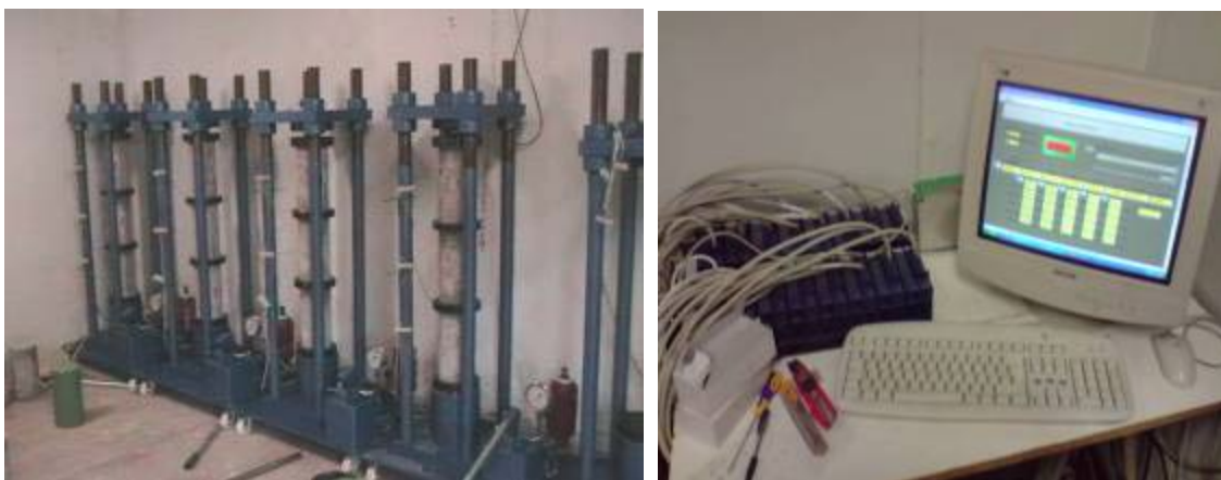
Ilustración 97, Grupo de Bastidores y equipo informático para ensayo de fluencia
