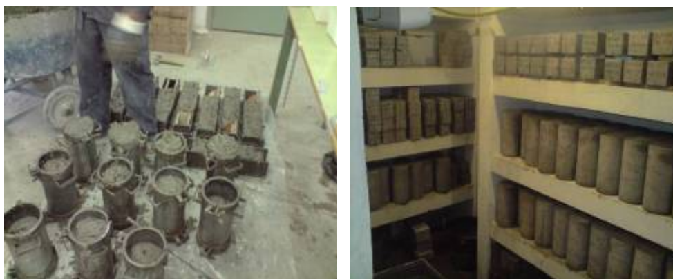
Ilustración 92, Fabricación y curado de probetas del estudio
