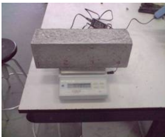
Ilustración 95, Registro de masa y deformación de probetas en ensayo de retracción.
