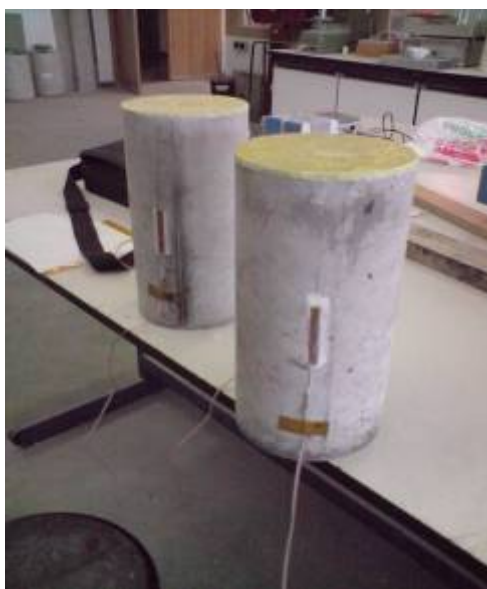
Ilustración 98, Detalle de bandas extensométricas adheridas a las probetas de hormigón.
