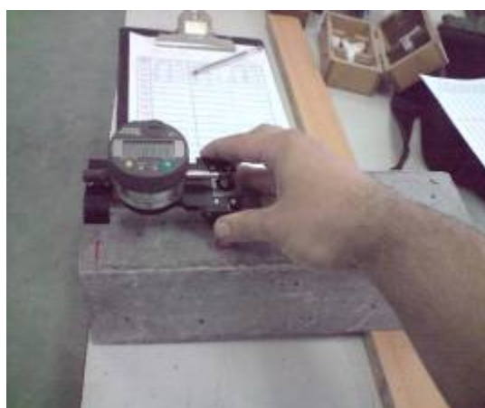
Ilustración 95, Registro de masa y deformación de probetas en ensayo de retracción.
