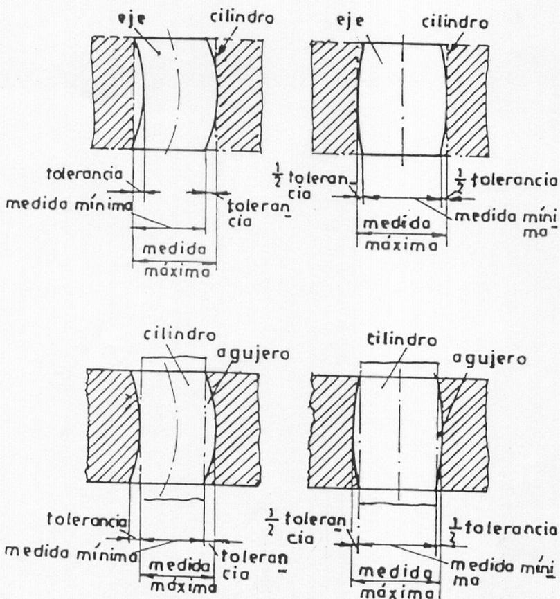
Para ejes, la superficie del elemento de forma no deberá sobrepasar a la forma geoméricamente ideal (cilindro) con la medida máxima (condición de envolvente). Además, la medida real no deberá quedar en ningún punto por debajo de la medida mínima.
