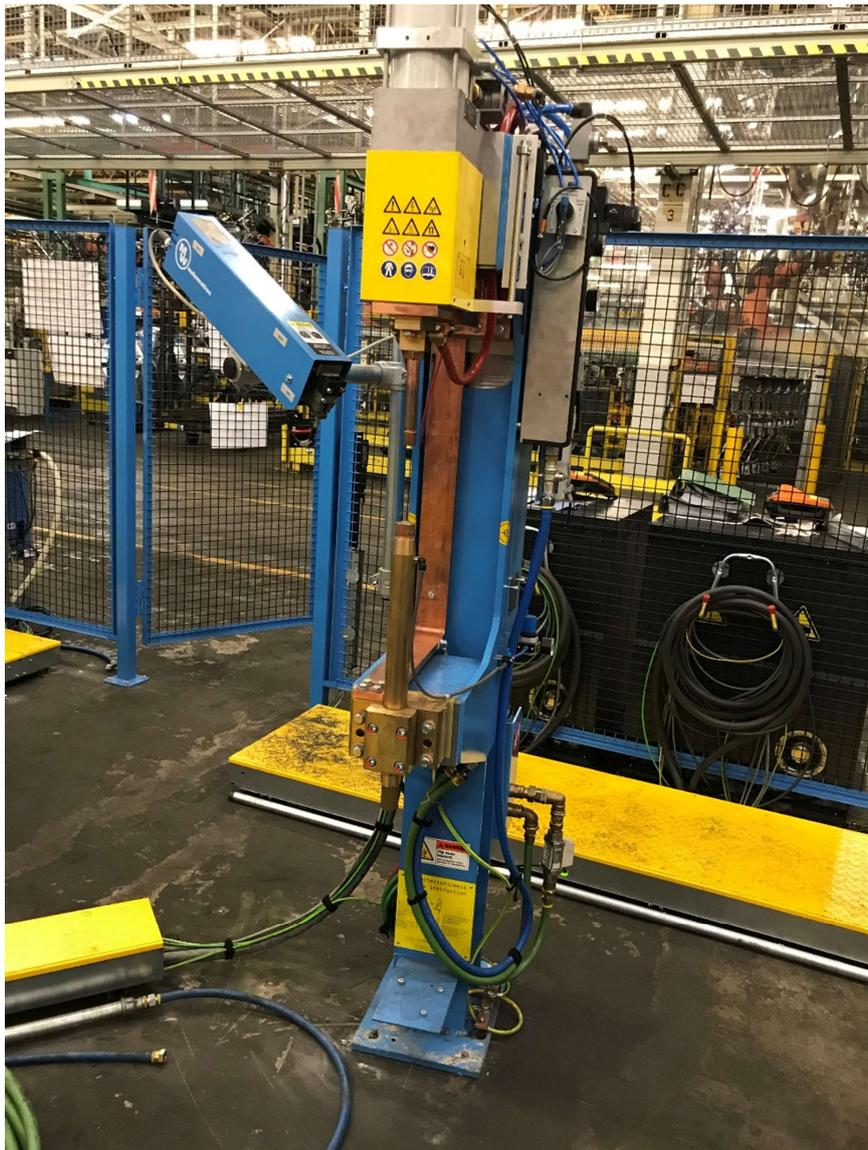
**Ilustración 15. Pedestal de soldadura con máquina LBPS del robot 210R1 [6]**
