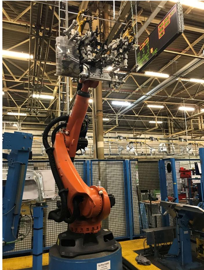
**Ilustración 13. Robot KUKA KRC4 210R1 [6]**
