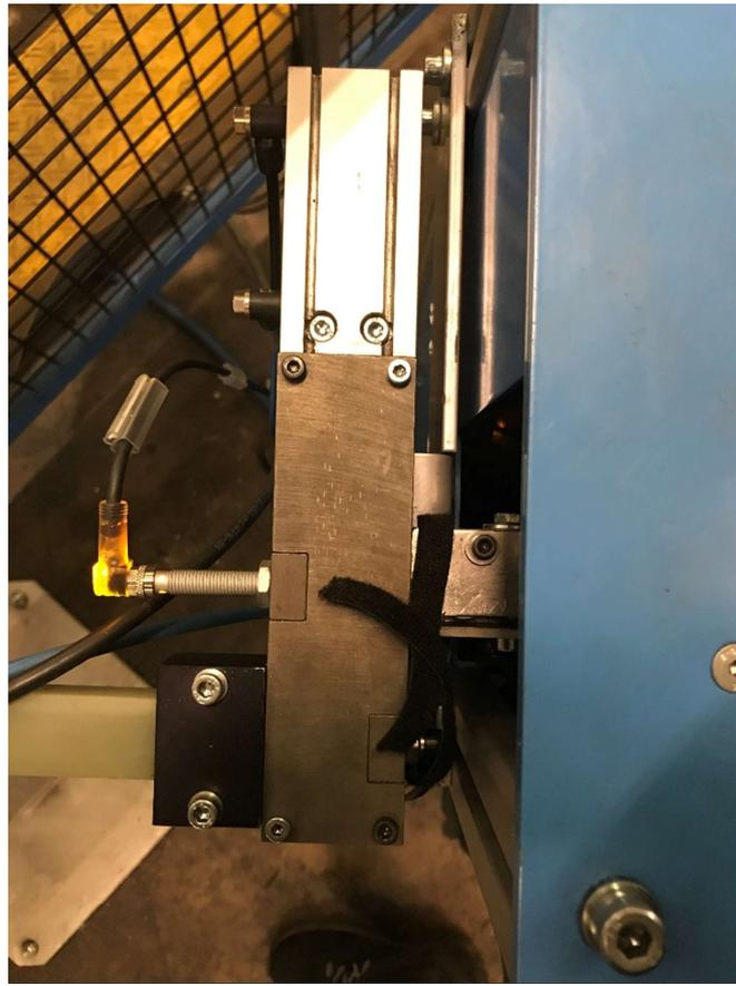
**Ilustración 16. Plataforma de lanzamiento del alimentador LBPS del robot 210R1 [6]**
