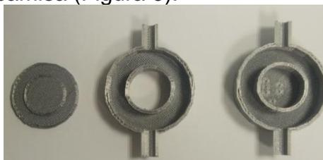
**FIGURA 6.** Sistema de medida para  $a_w$ . De izquierda a derecha: tapa, parte superior y parte inferior.
