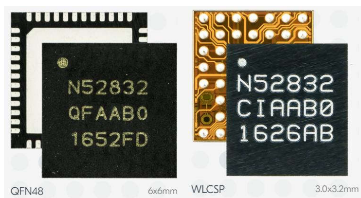
Ilustración 27 SoC de N52832 en diferentes encapsulados QFN48 a la izquierda y WLCSP a la derecha. Fuente: Nordic
