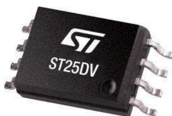
Ilustración 24 ST25DV64K en su encapsulado SO8 (4.9 x 6 mm). Fuente: STMicroelectronics
