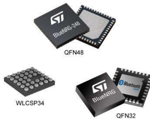
Ilustración 28 BlueNRG-2 en diferentes encapsulados QFN48 arriba, WLCSP34 a la izquierda y QFN32 a la derecha. Fuente: STMicroelectronics
