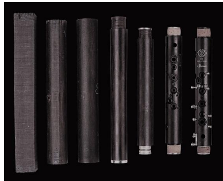
Fig. 6: Evolución constructiva parte superior clarinete. Fuente: Henri Selmer Paris (2019).
