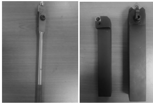
Fig. 9: Herramientas modificación interna del tubo. Fuente: Clarinetes Marvent (2019).
