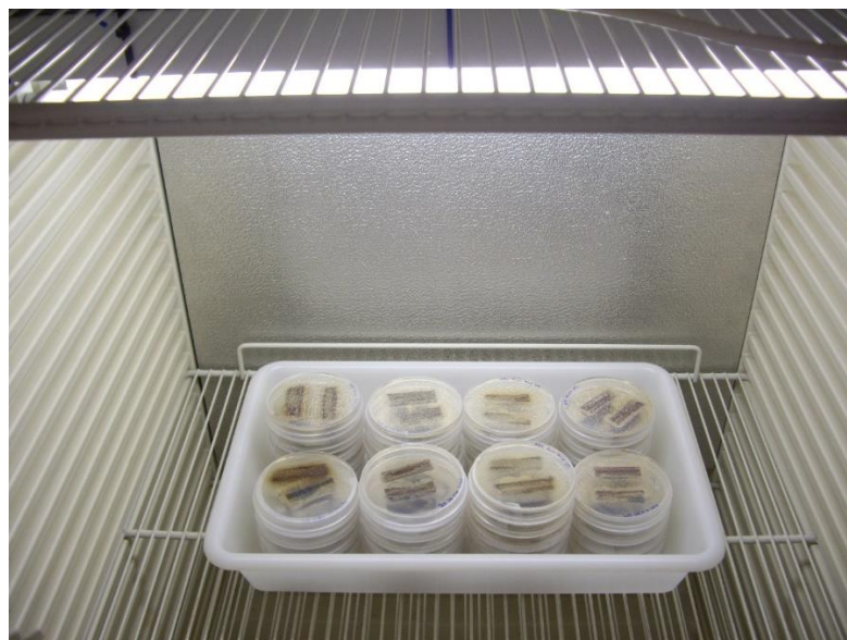
Figura 7. Placas Petri con fragmentos de madera e inoculadas con los hongos del estudio, depositadas en un incubador bajo luz blanca continua.
