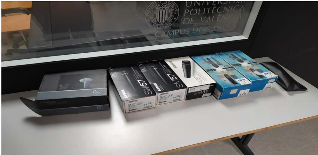
Figura 1. Parte del equipo utilizado para la grabación. De izquierda a derecha: AKG D112, 3 Shure SM57 y 2 AKG C1000S.
