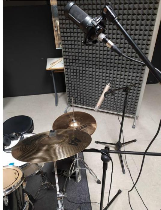
Figura 4. Colocación del micrófono aéreo para la captación global de la batería.
