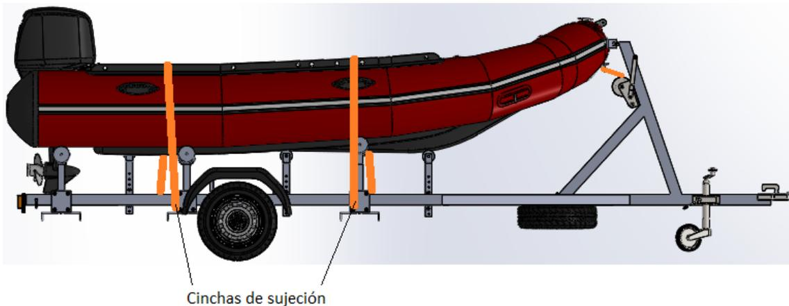
Figura 134: Esquema de sujeción de la embarcación
