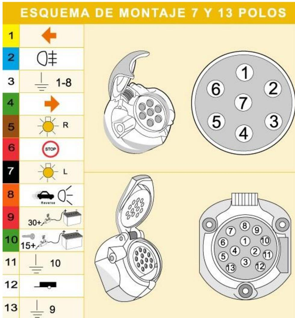
Figura 19: Esquema de conexión de polos
