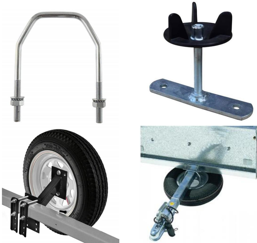
Figura 22: Diversos tipos de ubicación y soporte de rueda de repuesto
