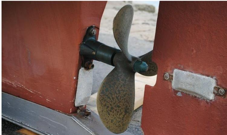
*Figura 156: Ejemplos de ánodos de sacrificio en embarcación*
