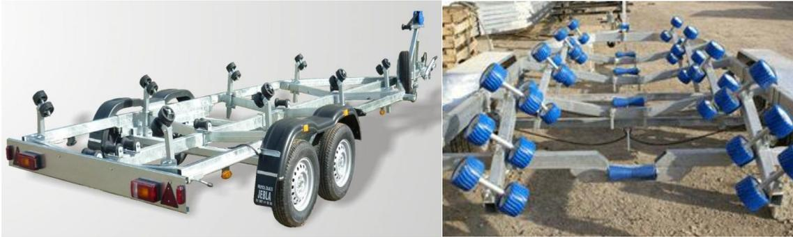
Figura 32: Remolques para embarcaciones de casco rígido
