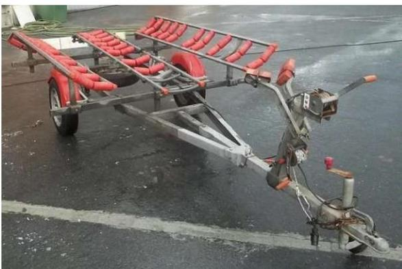
Figura 33: Remolque con rodillos
