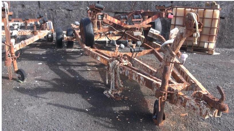
Figura 154: Remolque náutico completamente oxidado
