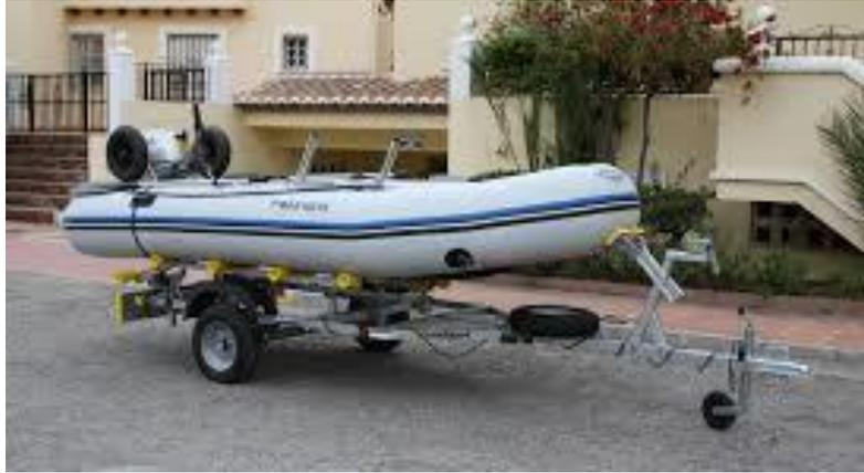
*Figura 9: Remolque náutico cargado*
