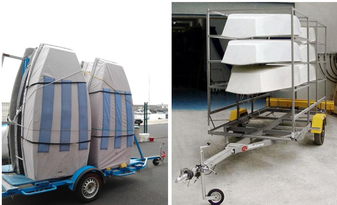
Figura 36: Remolques para embarcaciones de vela ligera
