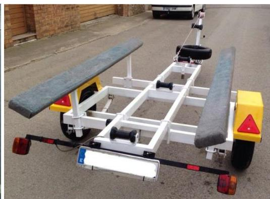
Figura 34: Remolque con deslizaderas
