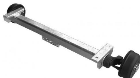
Figura 21: Eje con freno
