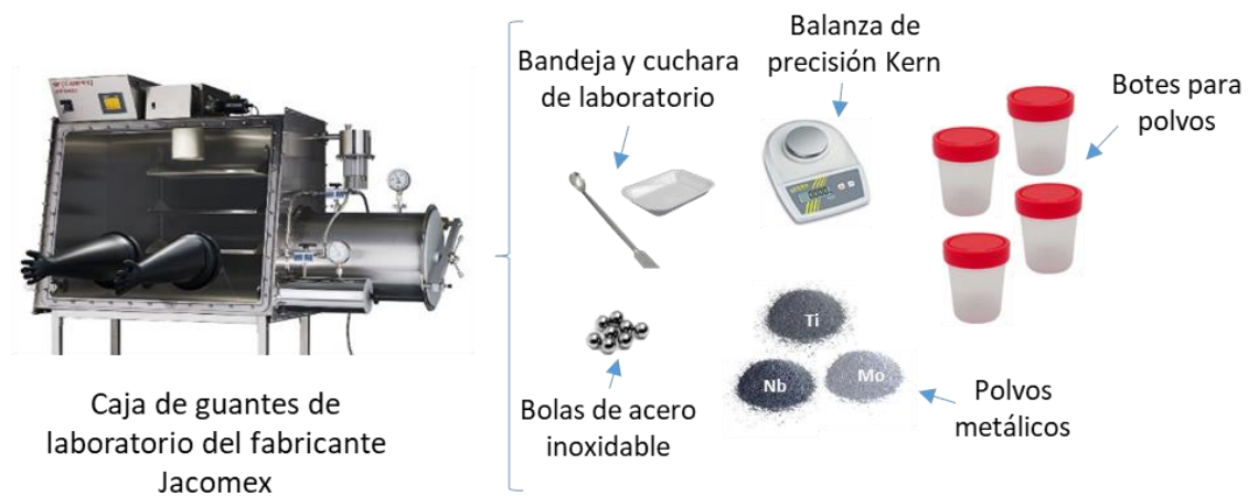
Figura 5.2. Máquina de guantes de laboratorio utilizada, equipada con los utensilios necesarios para la realización de las mezclas.
