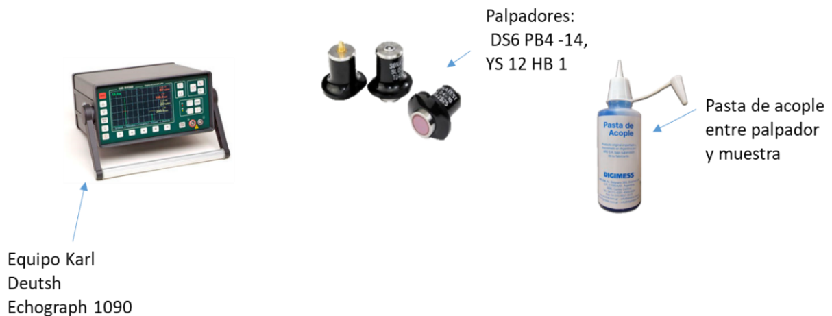
Figura 5.8. Equipo y materiales utilizados para el ensayo de ultrasonidos.
