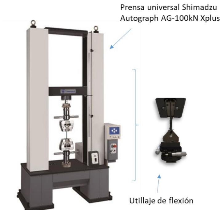
Figura 5.7. Equipo utilizado para realizar los ensayos de flexión a tres puntos.
