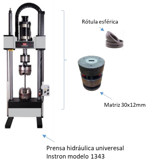
Figura 5.3. Maquinaria utilizada en la etapa de compactación de los polvos.
