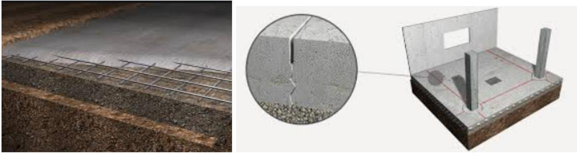
Figura 7.7: Solera de hormigón (izquierda) y juntas (derecha)
