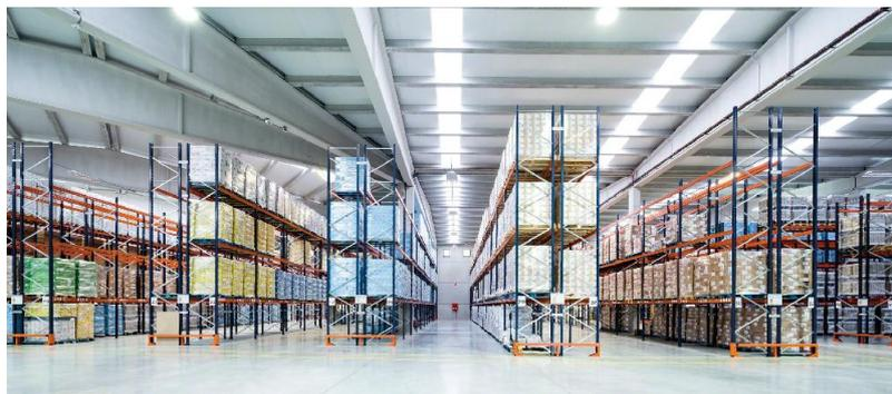
**Figura 6.1:** Sistema de estanterías metálicas convencional para producto paletizado [14]
