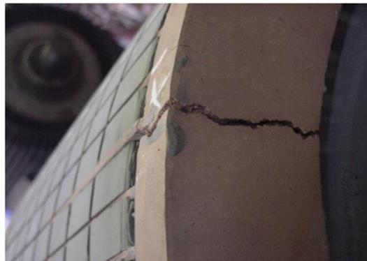
**Ilustración 5: Rotor de un motor de inducción con rotura en el extremo de las barras [9]**
