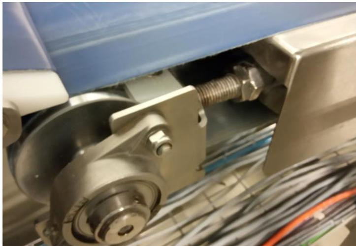
*Ilustración 12 Tensor rodillo extremos.*
