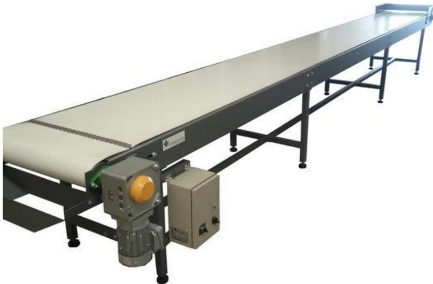
*Ilustración 8 Detalle motorreductor con sus inconvenientes de espacio*
