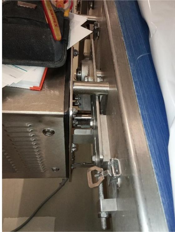
*Ilustración 11 Tensor por tornillo, accionando rodillo*
