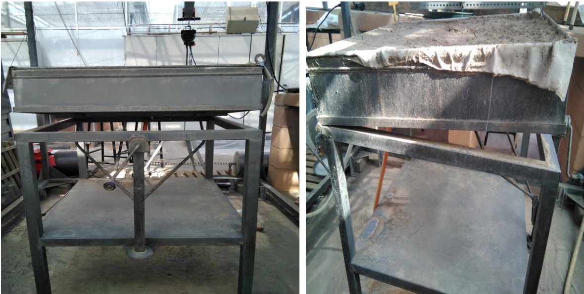
Figura 4. Detalles de una mesa de simulación con inclinación. Vista desde atrás y vista lateralmente.
