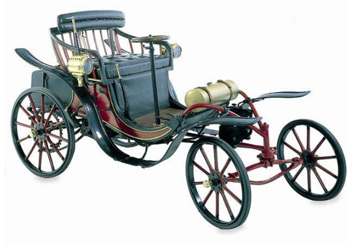
Figura 8. Vehículo equipado con sistema de dirección de eje pivotante.
