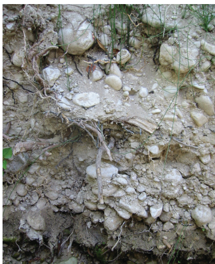
Figura 3.12: Còdols i graves en matriu arenosa-llimosa, en la plana d'inundació del Serpis (proximitats del casc urbà de l'Orxa)
