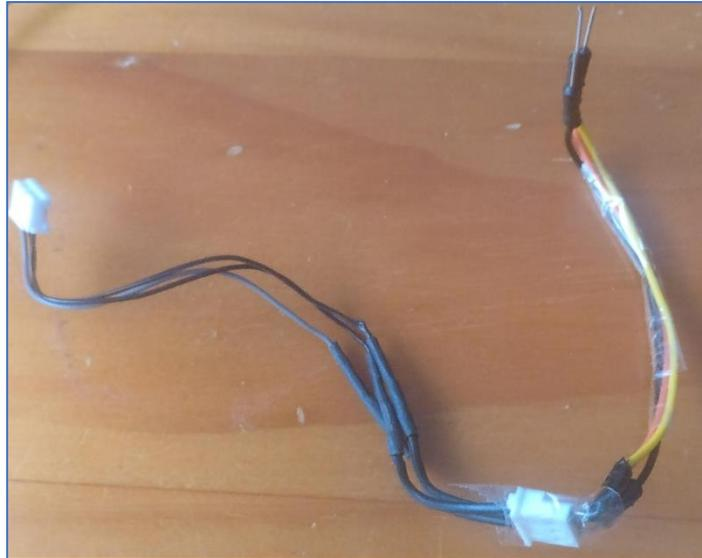
*Ilustración 9: Cable de comunicación Bioloid*
