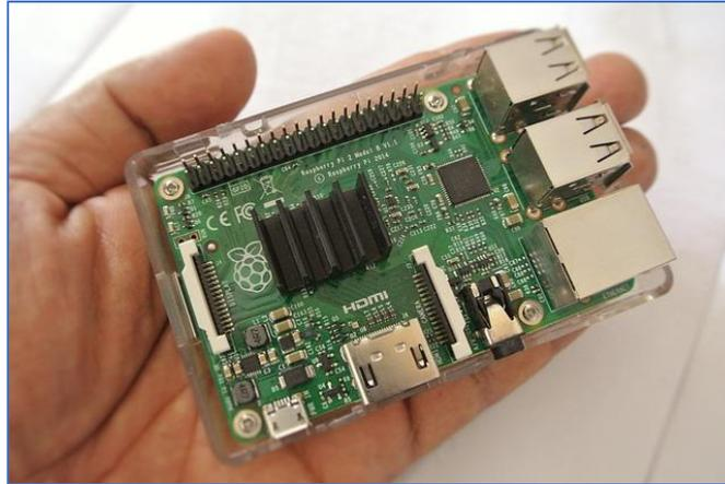
*Ilustración 3: Sistema Empotrado Raspberry Pi*
