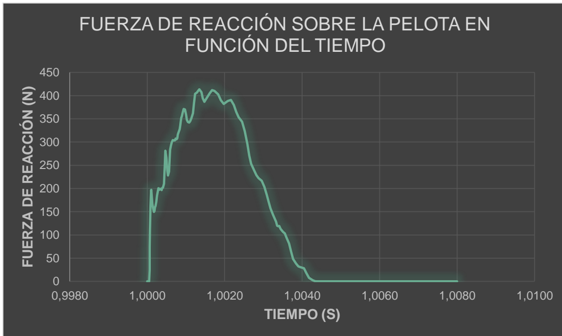
Ilustración 10. Fuerza de reacción sobre la pelota en función del tiempo
