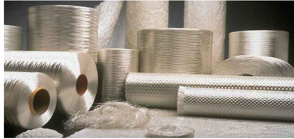
Ilustración 19. Ejemplo de las múltiples formas en que puede presentarse la fibra de vidrio, de acorde a su aplicación
