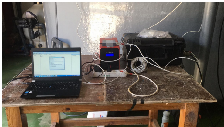
Figura 8: Sistema de ecosonda de 200 kHz completamente instalado y operando.
