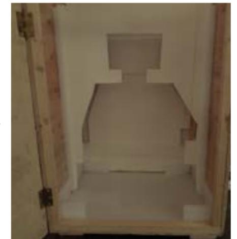
Fig. 19: Perfilado de Volara
