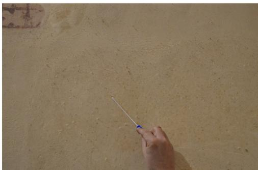
Figura 16 - Toma de muestras mediante hisopo en la zona de manchas de origen biológico
