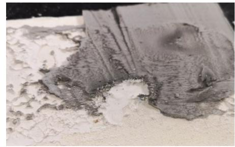
Figura 26. Restos adhesivo y estrato de intervención en el reverso de la pintura probeta P22
