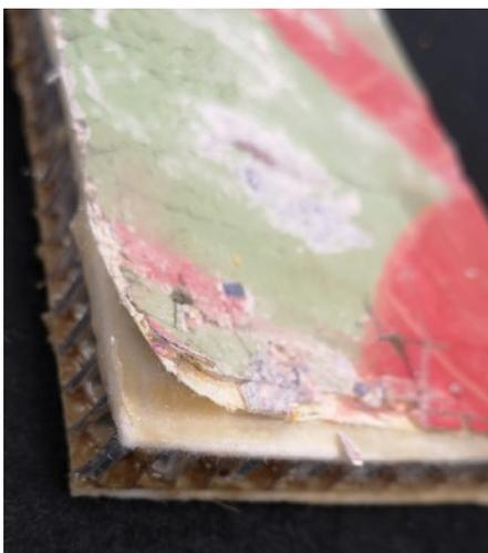
Figura 88. Exceso poder adhesivo probeta P40 con estrato de intervención fieltro 100% lana y Beva® OF GEL
