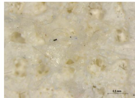
Figura 66. Detalle fibra estrato de intervención y adhesivo. Fotografía con lupa binocular del reverso pintura probeta P84
