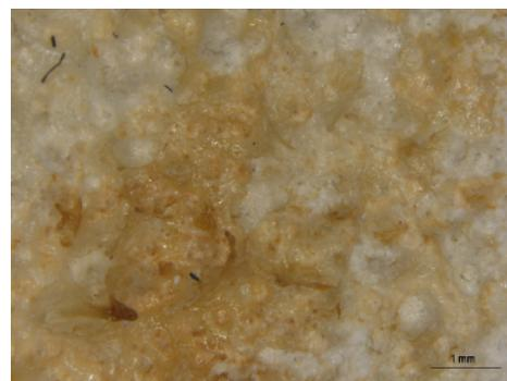
Figura 45. Restos espuma de poliuretano reverso pintura. Fotografía con lupa binocular probeta P132
