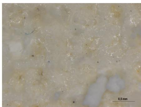
Figura 86. Fotografía con lupa binocular. Resto de adhesivo del reverso de la pintura probeta P157
