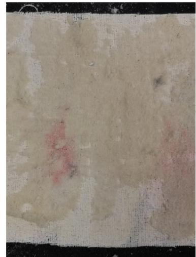
Figura 28. Restos adhesivo y estrato de intervención probeta P53
