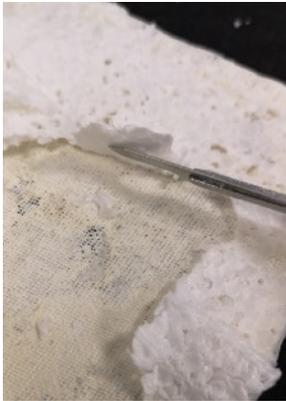
Figura 16. Eliminación mecánica estrato intervención probeta P14
