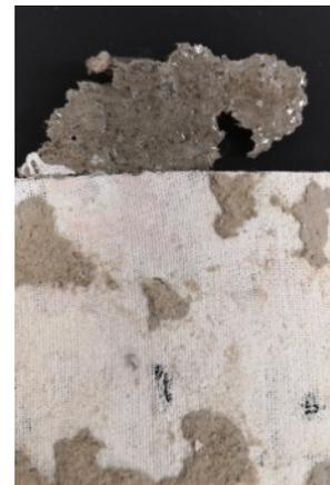
Figura 11. Resto adhesivo probeta P7
