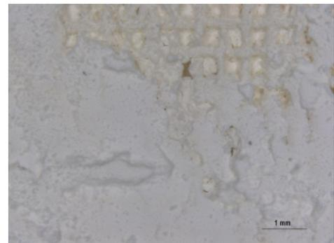
Figura 49. Restos de mortero en el reverso de la pintura probeta P139. Fotografía con lupa binocular
