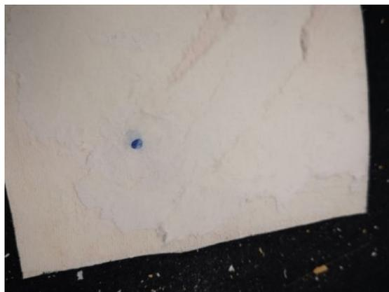
Figura 38. Restos adhesivo y estrato de intervención en el reverso de la pintura probeta P95
