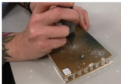
Figura 50. Realización orificios sobre el soporte
