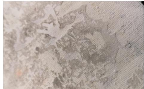
Figura 23. Manchas producidas por el estrato de intervención probeta P26
