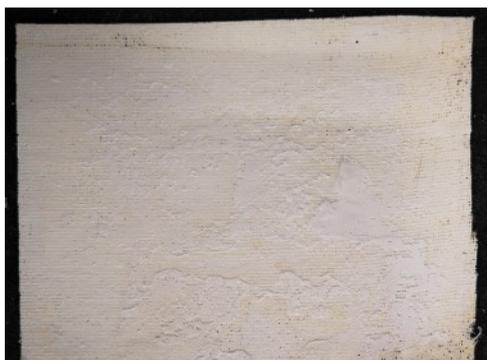
Figura 34. Restos adhesivo reverso pintura probeta P66
