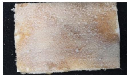
Figura 31. Restos adhesivo y estrato de intervención reverso pintura probeta P60
