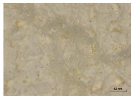
Figura 54. Fibras estrato de intervención junto a adhesivo. Fotografía con lupa binocular del reverso pintura probeta P34
