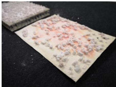
Figura 81. Restos de carga (perlita) en el reverso de la pintura probeta P138
