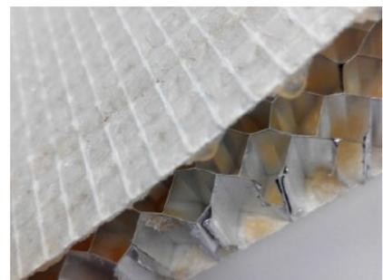
Figura 5. Detalle estructura soporte alveolar
