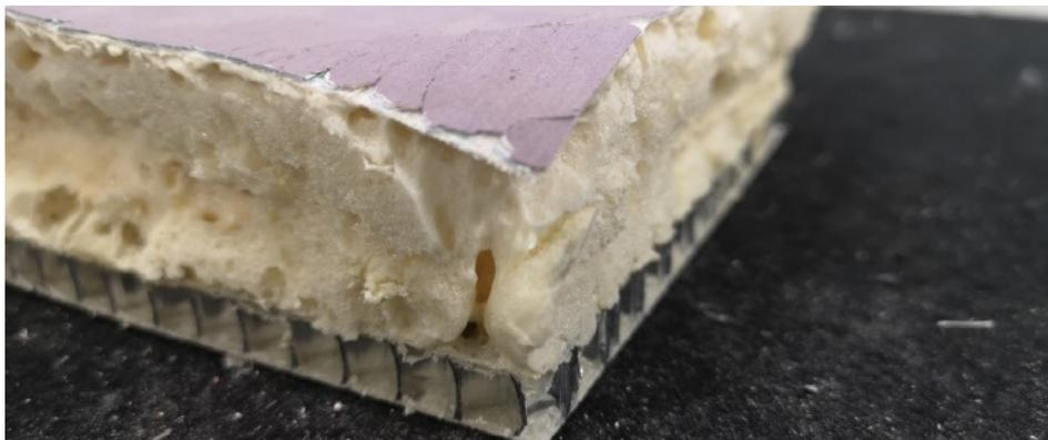
Figura 43. Estrato de intervención espuma de poliuretano P132
