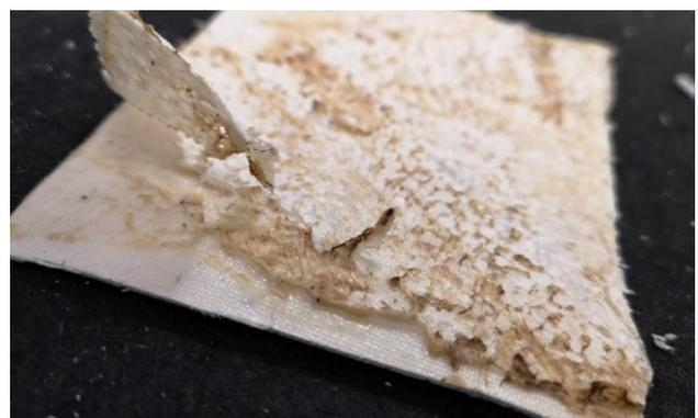
Figura 18. Restos de adhesivo y estrato de intervención probeta P20
