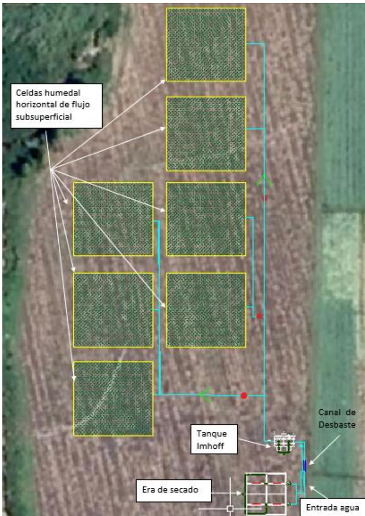
Figura 16. Esquema general de sistema de tratamiento de agua residual domestica del paraje La Secadora. Humedal artificial horizontal de flujo subsuperficial.
