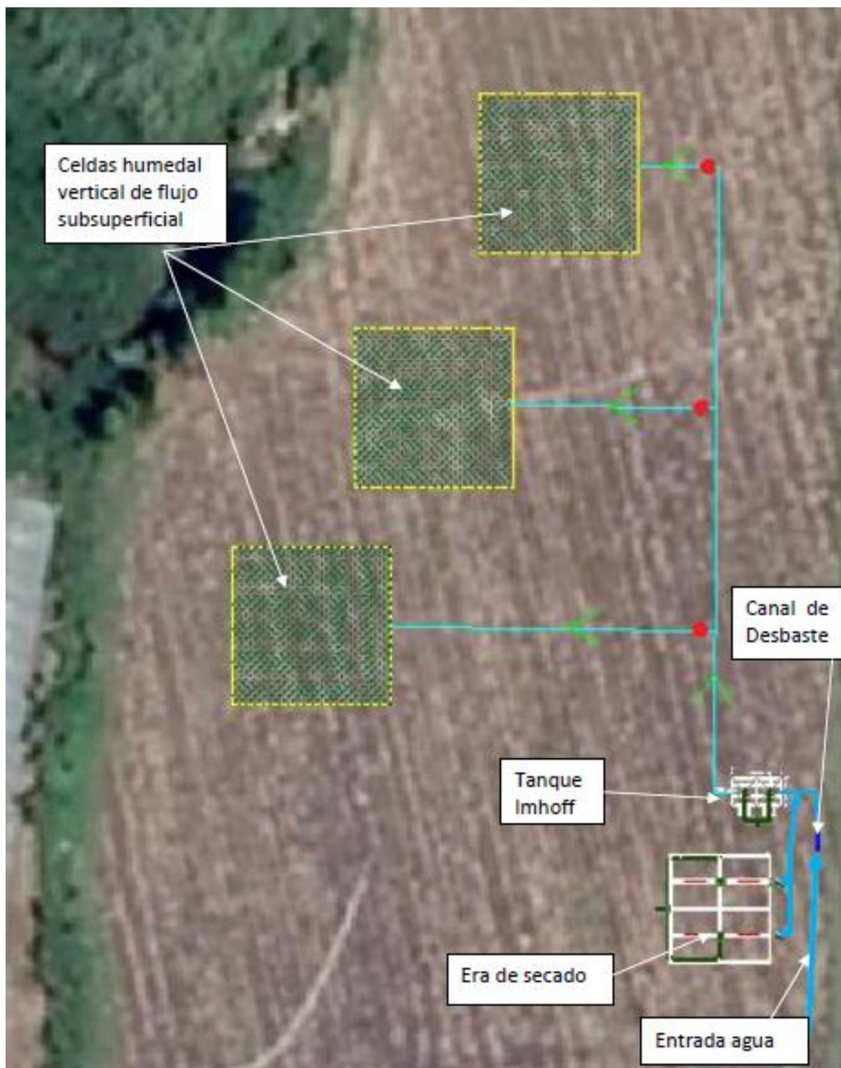
Figura 15. Esquema general de sistema de tratamiento de agua residual domestica del paraje La Secadora. Humedal artificial vertical de flujo subsuperficial.
