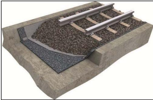
Ilustración 26. Manta bajo balasto (Specifier, 2019)
