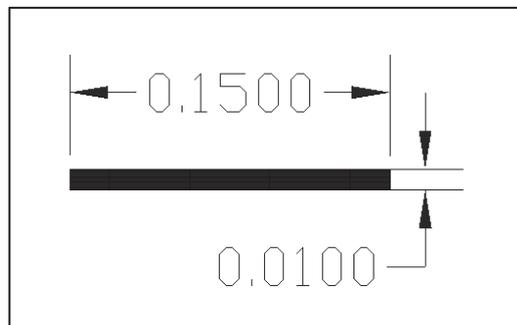
Ilustración 33. Representación gráfica del rail pad (cotas en metros)
