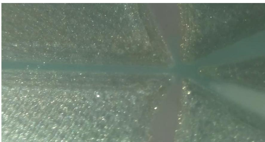
**Figura 115: Prueba del flujo con colorantes, flujo hacia arriba. Fuente propia**
