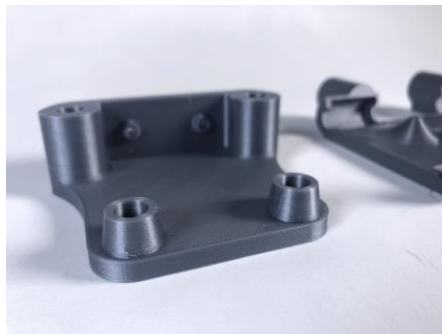
Figura 5 Detalle piezas impresas 3D PLA
