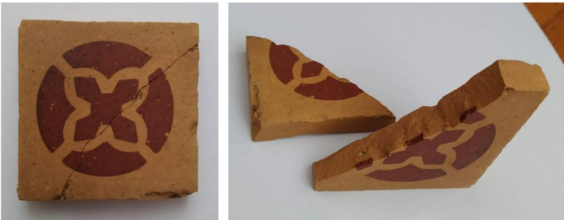
Fig. 28 Encáustica. En la segunda imagen puede apreciarse el doble prensado.
