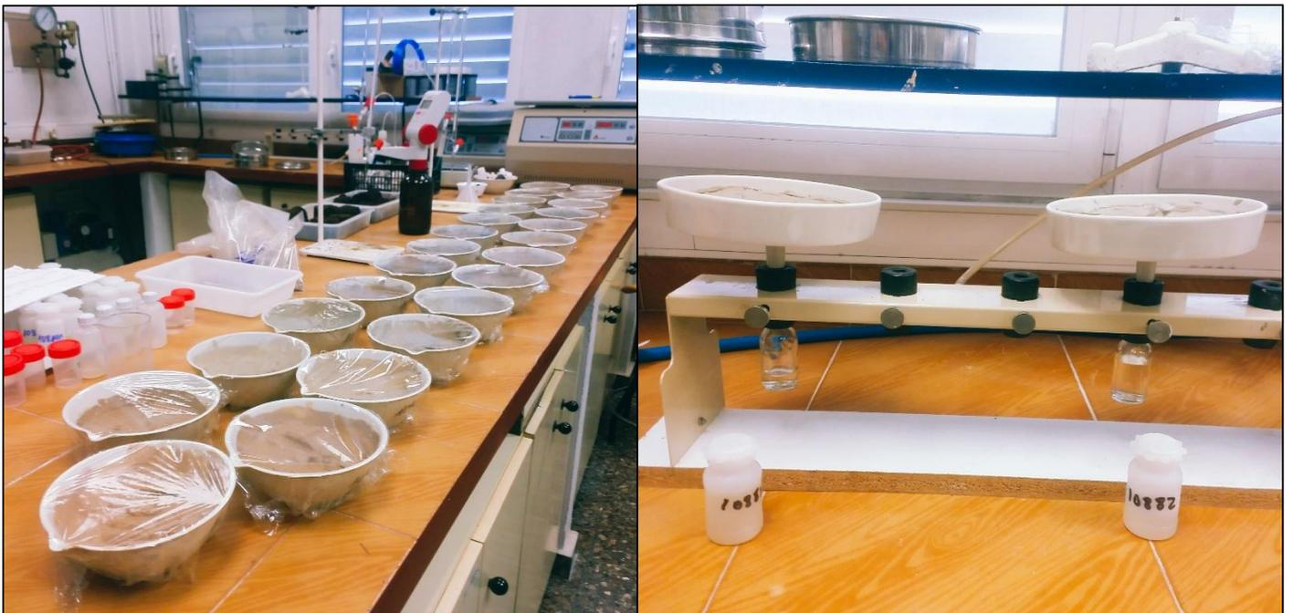
*Figura 4.- Preparación de pasta saturada, y extracción de sales después de 24 horas mediante embudo de Büchner*
