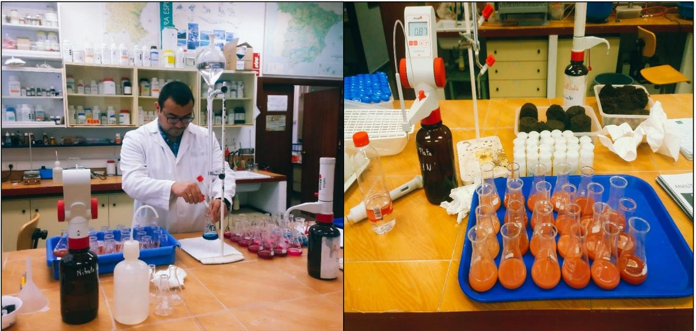
*Figura 5.- Determinación volumétrica de Magnesio (fig. izq.), y Determinación de cloruro (fig. dcha.).*
