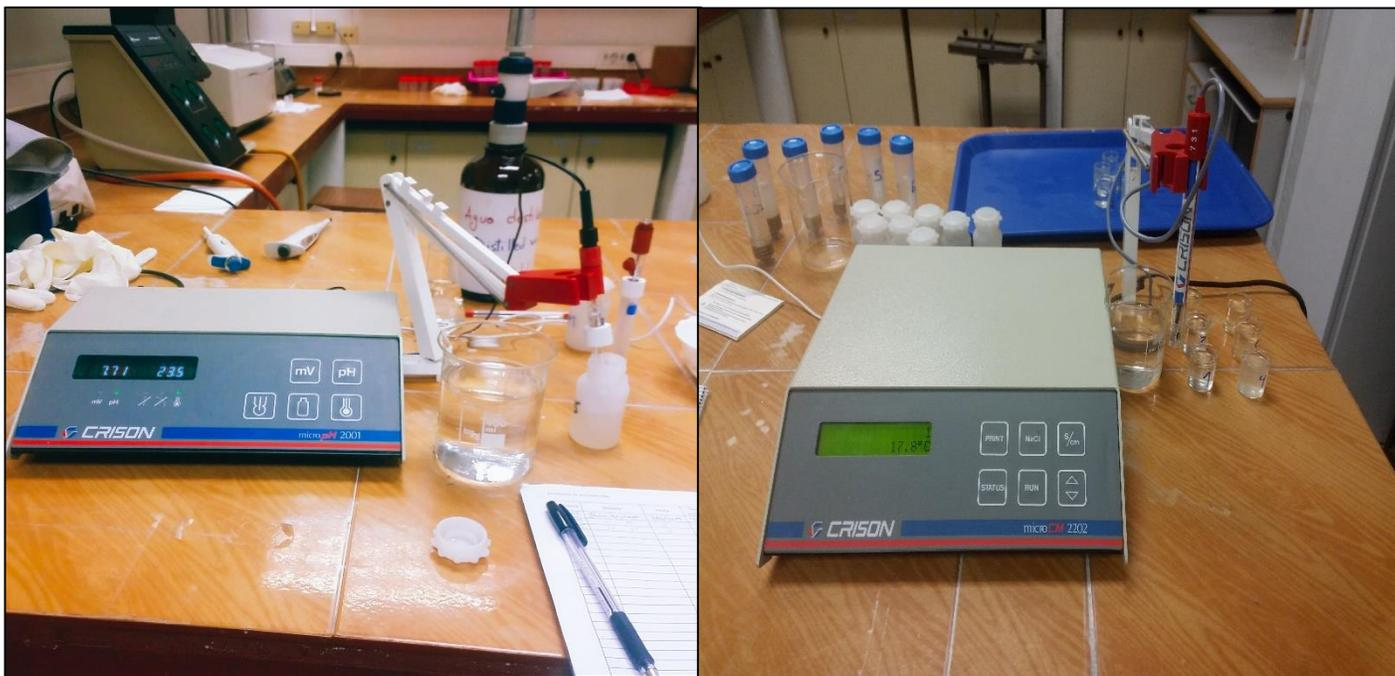
Figura 7.- Determinación de pH (fig. izq.), y Determinación de CE (fig. dcha.).
