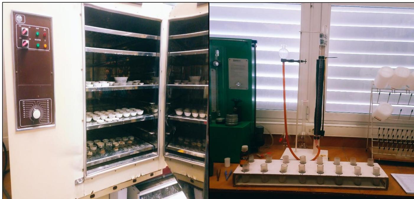
Figura 8.- Determinación de humedad y materia orgánica (fig. izq.), y Determinación de carbonatos (fig. dcha.).
