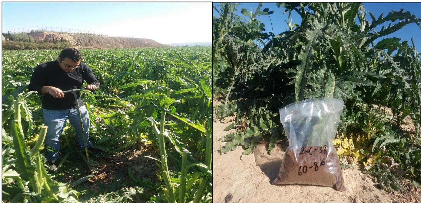
*Figura 2.- Extracción de muestra de suelo en campos de cultivo de alcachofa (calicata 2-c-58), utilizando barrena Eijelkamp*
