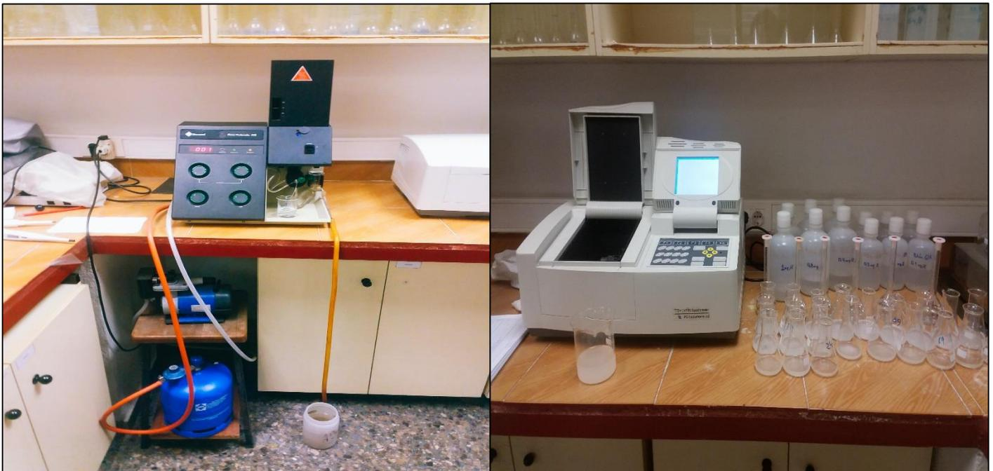
*Figura 6.- Determinación de soido y potasio (fig. izq.), y Determinación de sulfato (fig. dcha.).*
