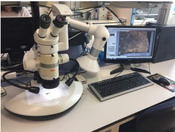
Fig.11. Lupa binocular de alto alcance. Foto de autoría.
