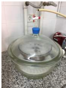
Fig.73. Baño al vacío. Consolidación en olla . Archivo SIP.
