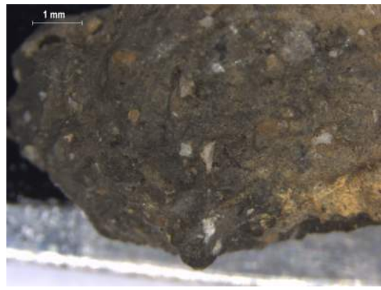
Fig.15. Resultados Lupa muestra M2 (7.536). Se observa la gran granulometría de sus componentes. Foto de autoría.
