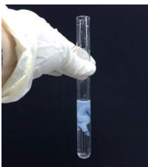
Fig.53. Prueba de cloruros mediante análisis cualitativo. Archivo SIP.
