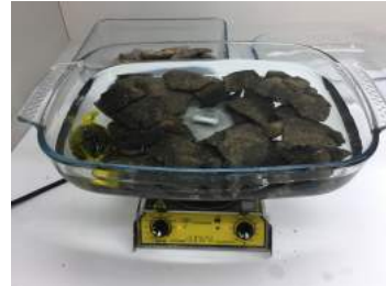
Fig.68. Baño de hexametáfosfato de sodio en cuenco . Archivo SIP.
