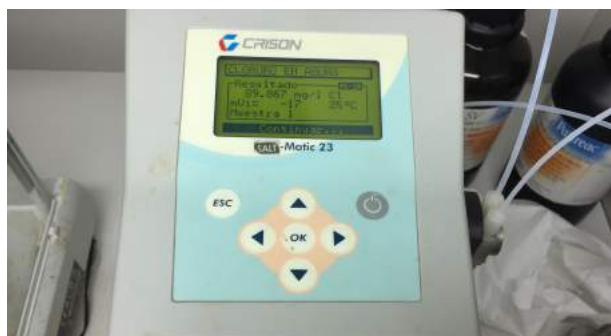
Fig.54. Prueba de cloruros mediante un Titrador. Archivo SIP.
