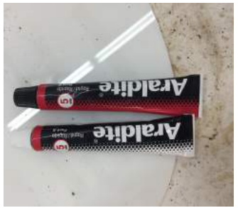
Fig.82. Resinas epoxídica empleada como adhesivo. Archivo SIP.
