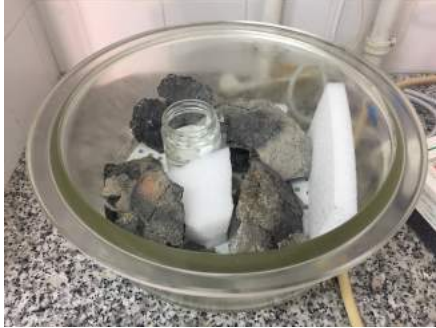
Fig.63. Desmontaje con vapores de acetona en cuenco. Archivo SIP.
