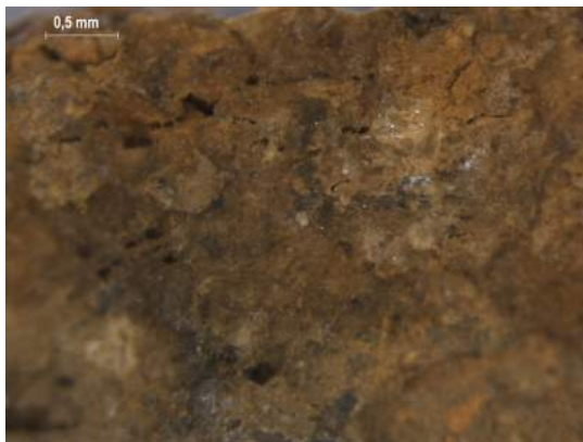
Fig.14. Resultados Lupa muestra M1 (7.523). Se observan claramente restos de adhesivos y su alta porosidad. Foto de autoría.
