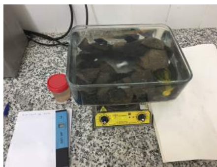
Fig.70. Desalación con agitador con y temperatura en cuenco. Archivo SIP.
