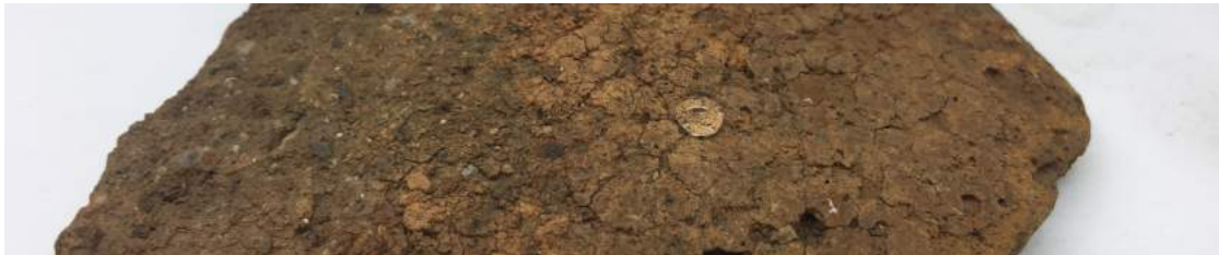
Fig.55. Prueba de tensión superficial tras el ensayo de consolidación en un fragmento. Archivo SIP.
