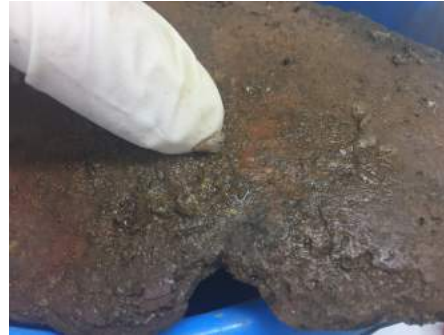
Fig.66. Restos de adhesivos por consolidantes, reblandecidos tras el baño de acetona. Archivo SIP.
