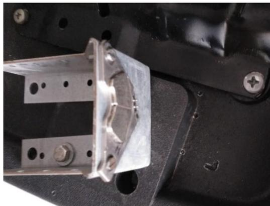
*Ilustración 62: detalle del tope de fin de giro del prototipo. (Solano, 2019)*
