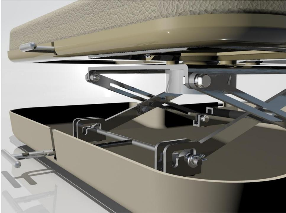
*Ilustración 77: detalle del mecanismo de elevación. (Solano, 2019)*
