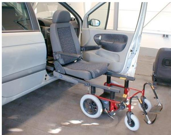
*Ilustración 3: sistema de intercambio asiento de vehículo - silla de ruedas Turny. Extraído de Tacoval.*
