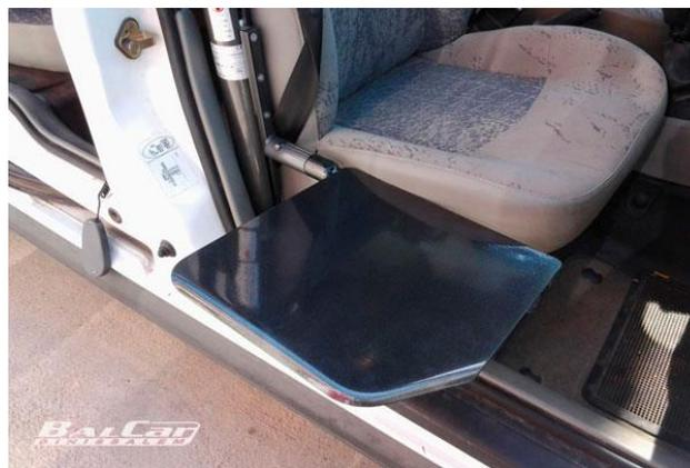
*Ilustración 2: tabla de transferencia montada en vehículo. Extraído de BalCar Binissalem.*
