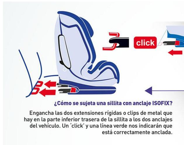
*Ilustración 18: funcionamiento esquemático del sistema ISOFIX. Extraído de Fundación MAPFRE.*
