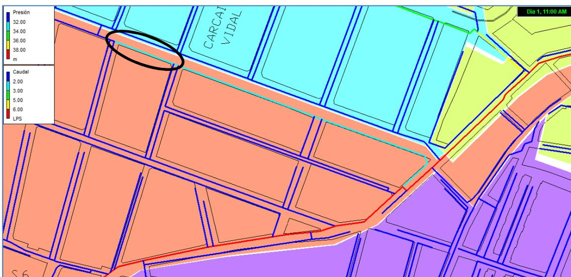
Fig. 81 Localización de tubería en la que se provoca la rotura en el sector 6
