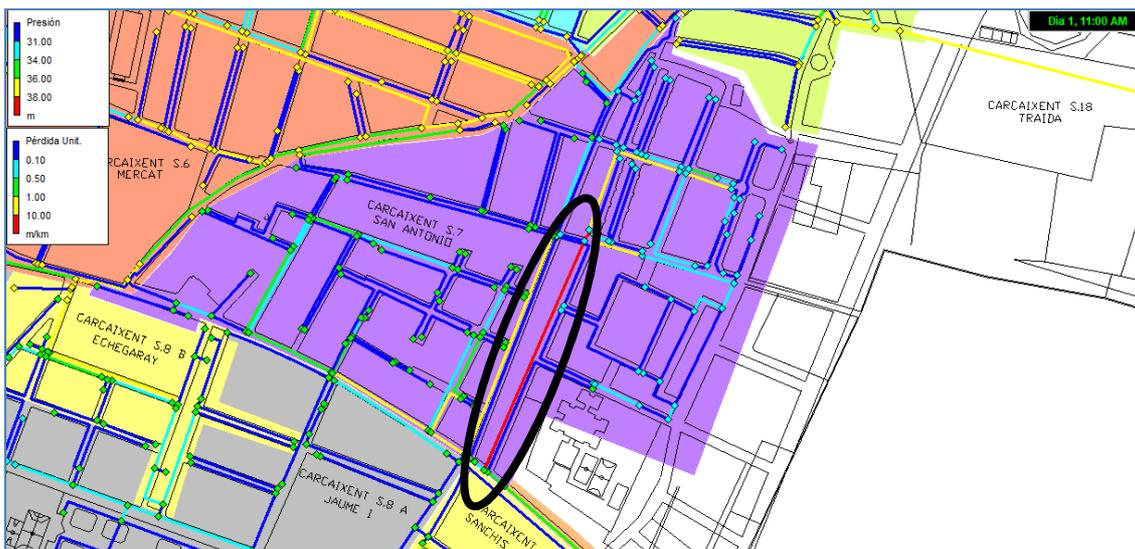
Fig. 72 Identificación de la tubería con pérdida de carga unitaria alta en el sector 7
