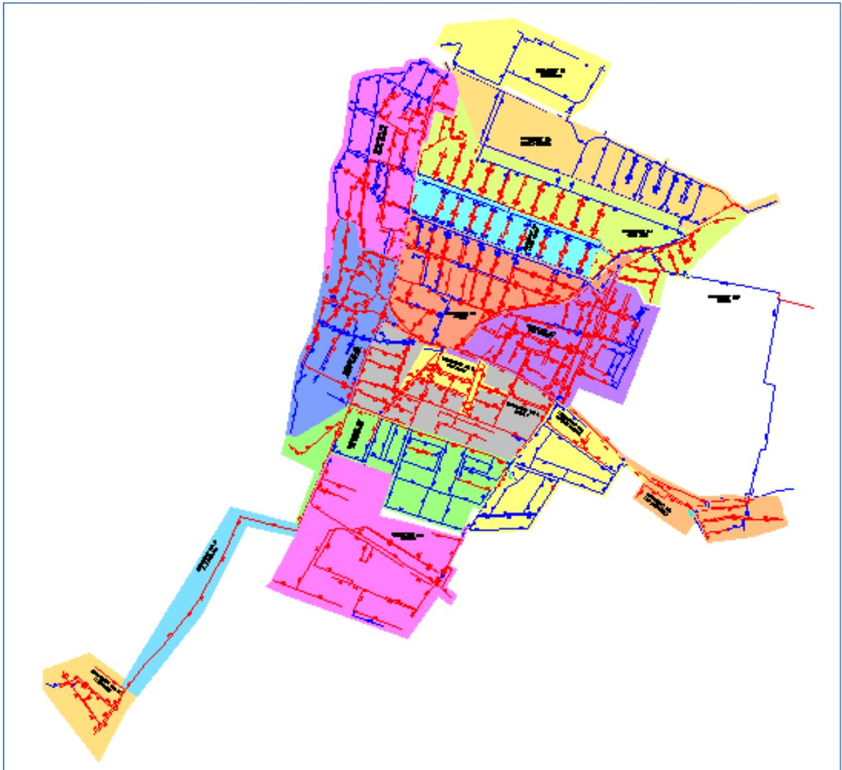
*Fig. 102 Identificación de las tuberías de fibrocemento existentes en la red (en color rojo)*
