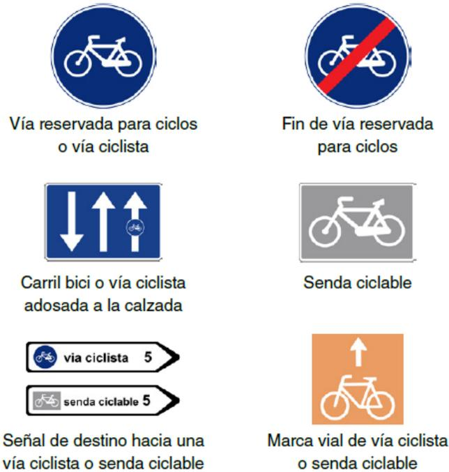
Figura 46. Señalización ciclista (vertical y horizontal)
