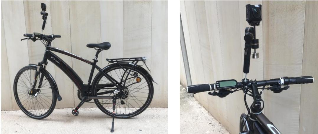
Figura 124. Bicicleta instrumentada
