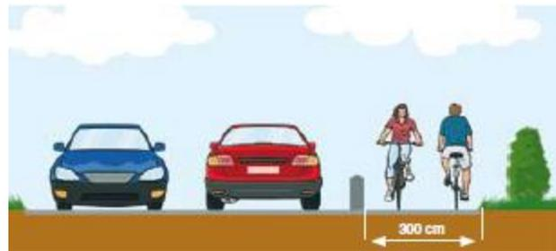
Figura 7. Carril bici protegido bidireccional
