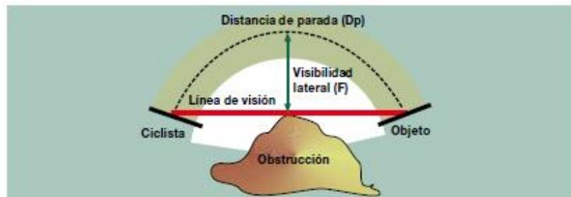
Figura 15. Esquema de curva para el cálculo de la visibilidad lateral
