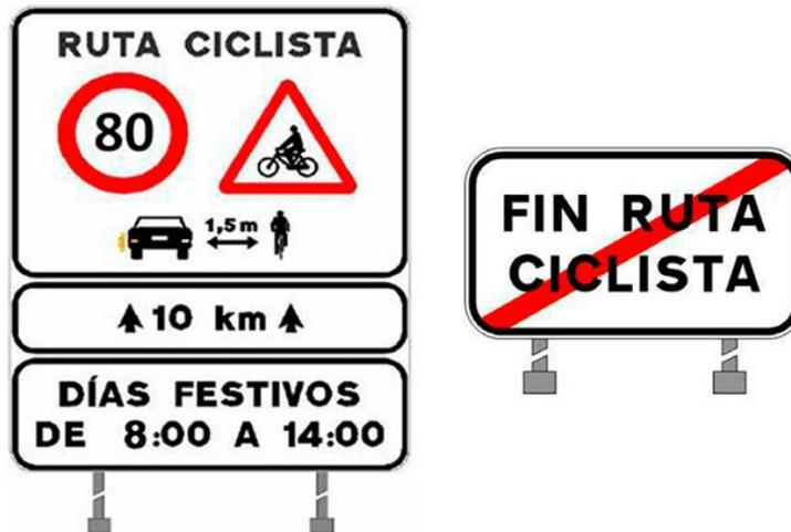
*Figura 50. Ejemplo de modelo de señalización fija
