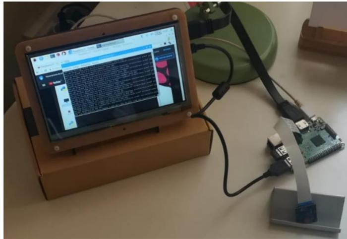
Figura 61. Equipo para la visión de microfluidos.
