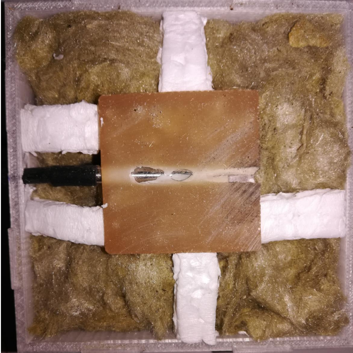
Ilustración 32 Vigas de poliestireno expandido centrando la referencia caliente
