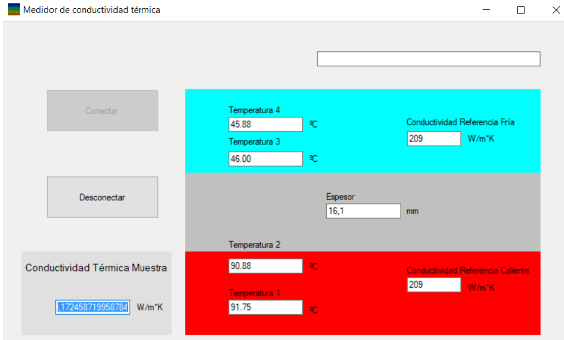
Ilustración 39 Ensayo con contrachapado
