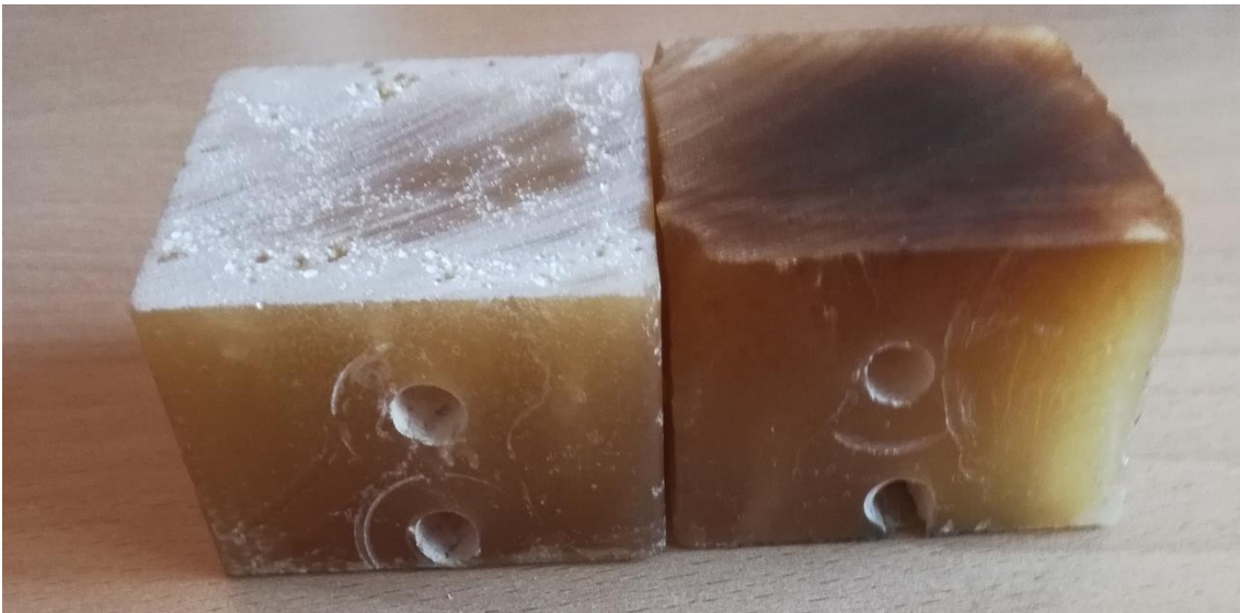
Ilustración 21 Referencias con agujeros para los termopares
