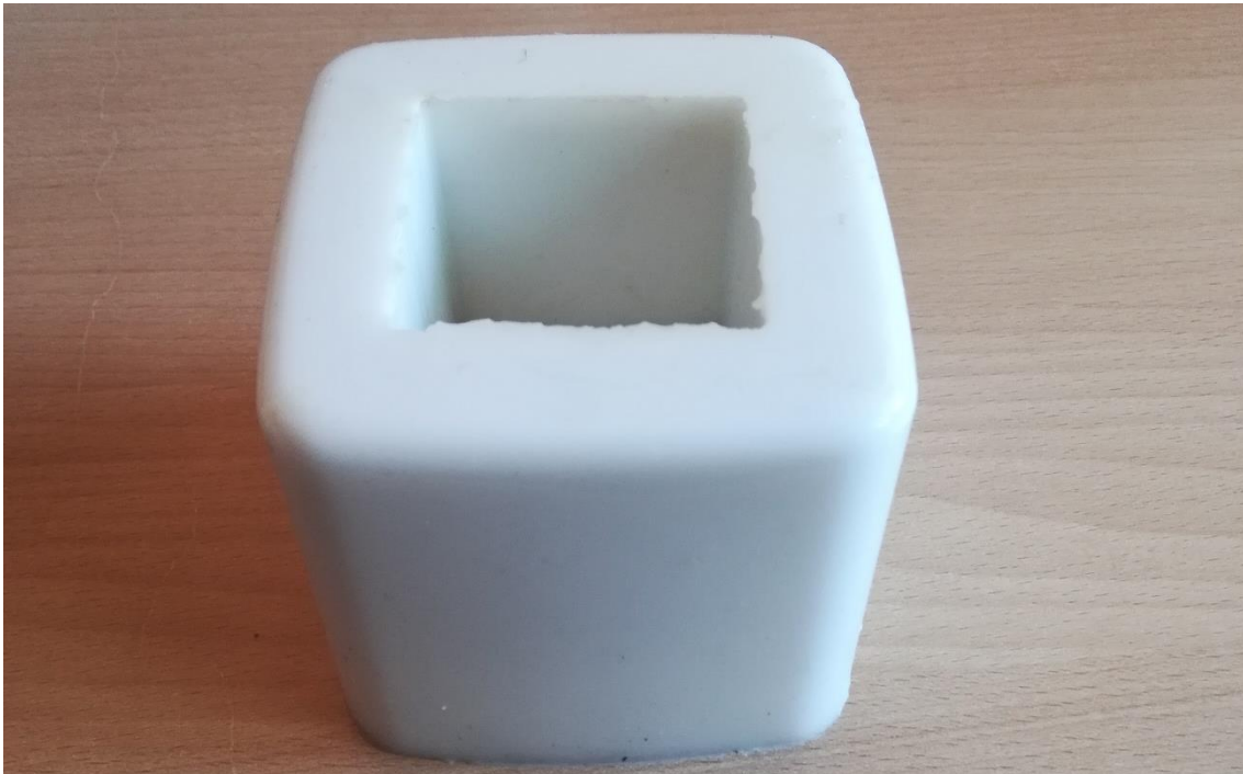
Ilustración 18 Molde para piezas de referencias
