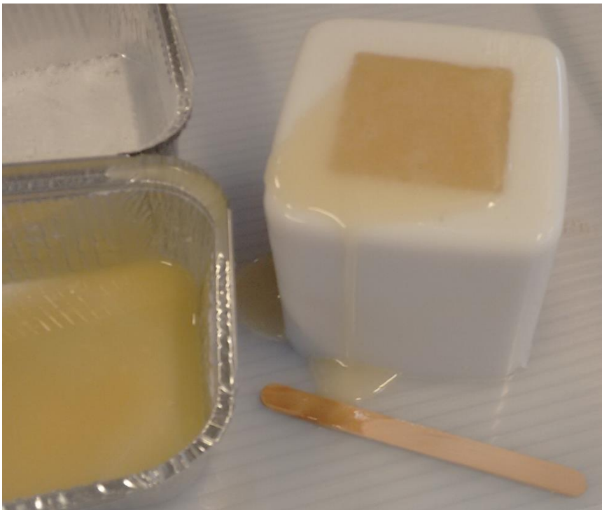
Ilustración 19 Referencia curándose dentro del molde
