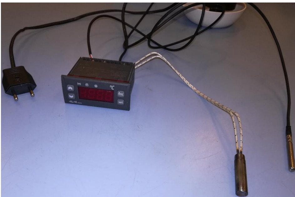
Ilustración 26 Termostato con la resistencia térmica y el termopar que lo controla
