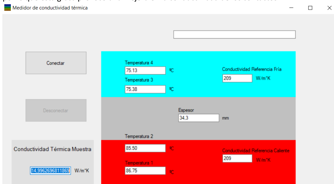
Ilustración 37 Resultados con prototipo 3 con grasa de silicona
