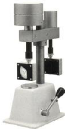
Figura 12. Fotografía del durómetro 673-D de J. Bot Instruments empleado en la caracterización de la dureza de los materiales desarrollados.
