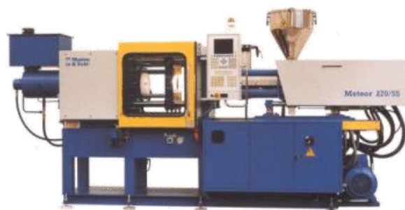
Figura 7. Fotografía de la máquina de inyección Meteor 270/75 de Mateu& Solé empleada en la fabricación de probetas normalizadas para la caracterización de las mezclas desarrolladas.
