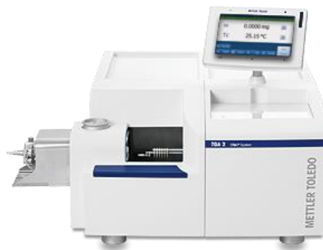
Figura 17. Fotografía del equipo TGA de Mettler Toledo empleado para el estudio termogravimétrico de los materiales desarrollados.
