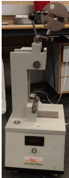
Figura 13. Fotografía del equipo Impacto Charpy de Metrotec con maza de 6 J empleado en la caracterización frente a impacto de los materiales desarrollados.
