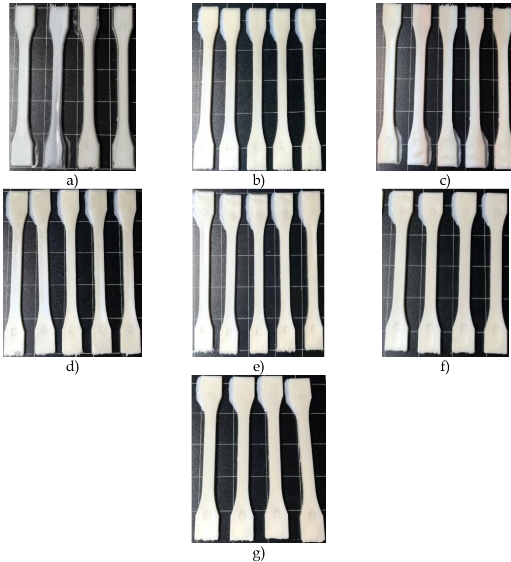
Figura 8. Fotografía de las probetas inyectadas (probetas para ensayo de tracción) correspondientes a a) PET100, b) PET90, c) PET80, d) PET70, e) PET70Xibond1, f) PET70Xibond3 y g) PET70Xibond5.
