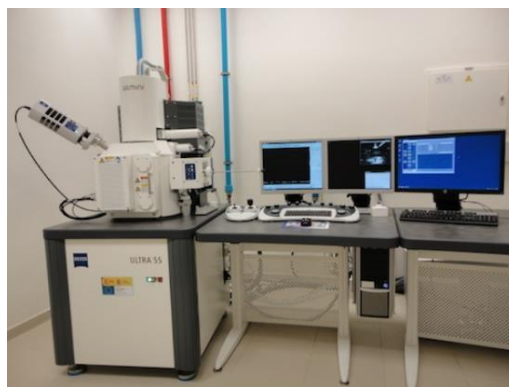
Figura 15. Fotografía del microscopio electrónico de barrido con emisión de campo de Oxford Instruments empleado en la caracterización de la morfología de las superficies de fractura de los materiales desarrollados.
