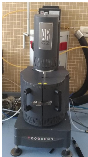
Figura 19. Fotografía del reómetro oscilatorio AR-G2 con cámara y mordazas para trabajar con muestras sólidas y llevar a cabo la caracterización térmico-mecánico-dinámica de los materiales desarrollados.
