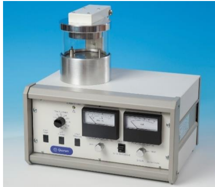
Figura 14. Fotografía del equipo recubridor o “sputter-coater” SC7620 Quorum Technologies empleado para depositar una fina capa conductora sobre la superficie de fractura de los materiales desarrollados.
