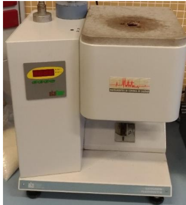
Figura 18. Fotografía del equipo índice de fluidez de Metrotec empleado en la caracterización del MGFI de los materiales desarrollados.
