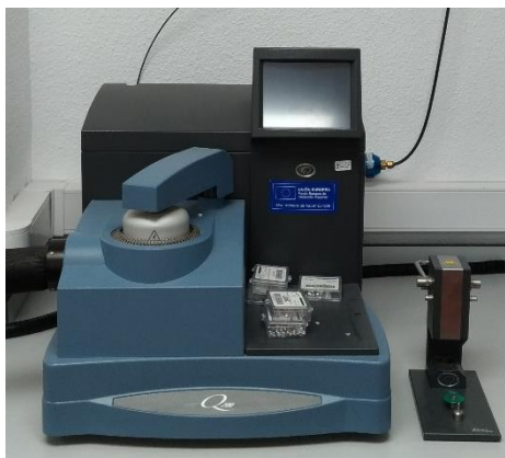
Figura 16. Fotografía del equipo DSC Q-200 de TA Instruments y prensa de preparación y cierre de crisoles empleados en la caracterización de las transiciones térmicas de los materiales desarrollados.
