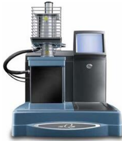
Figura 20. Fotografía del termoanalizador TMA Q-400 para la obtención de coeficiente de expansión térmica lineal (CLTE) de los materiales desarrollados.
