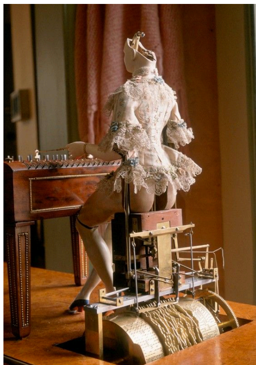
Fig. 7. Vista trasera de la Timpanista en la que se puede apreciar su mecanismo y el cilindro programado.
