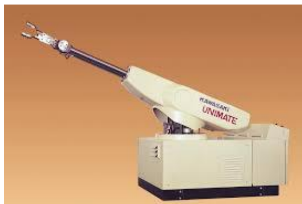
Figura 2. Unimate. Primer robot industrial.
