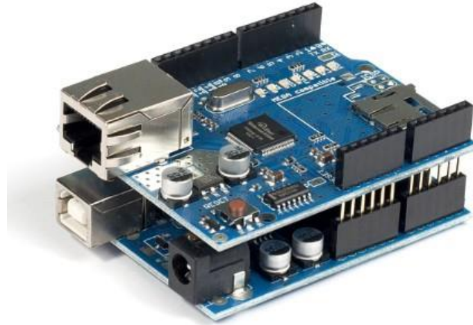
Figura 25. Módulo Ethernet Shield montado sobre la placa de Arduino UNO.
