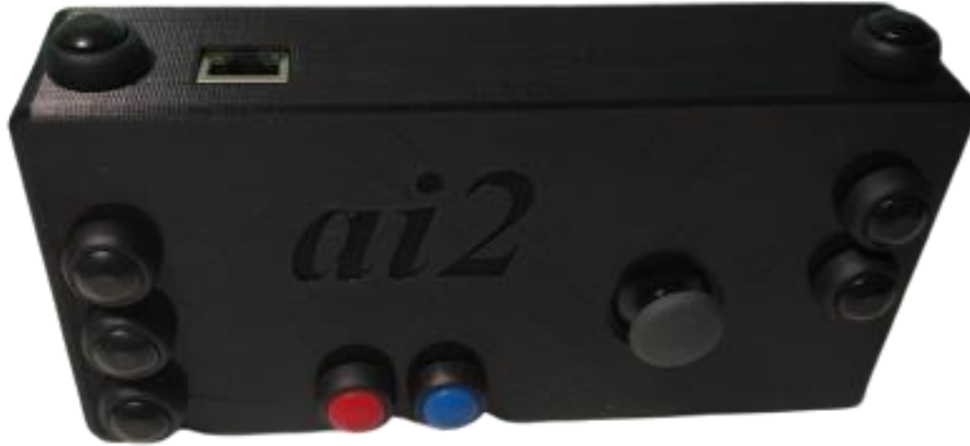
Figura 64. Mando diseñado impreso y montado.
