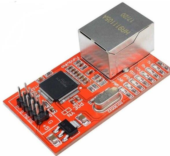
Figura 26. Módulo independiente con W5100.
