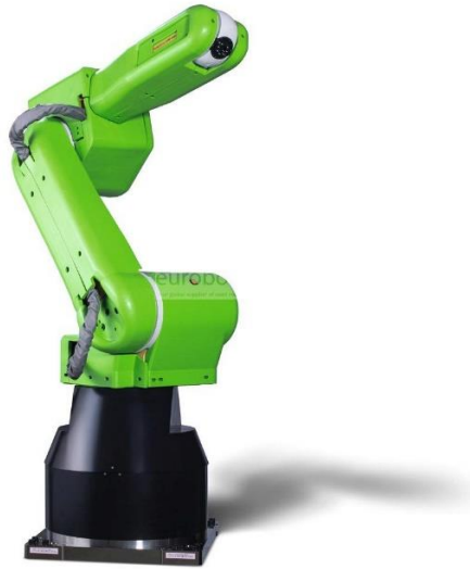
Figura 10. Robot colaborativo CR-35iA de FANUC.
