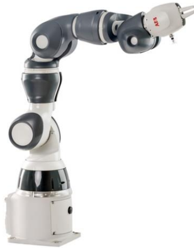
Figura 9. Robot colaborativo YuMi single arm de ABB.
