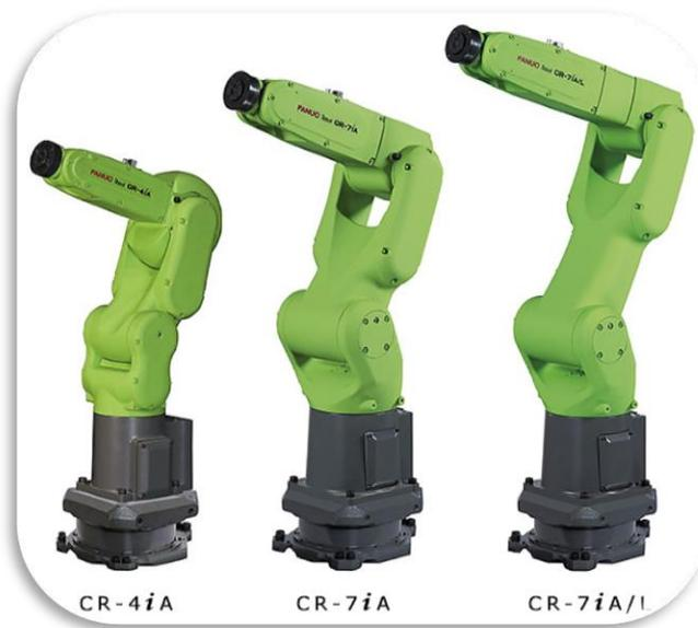
*Ilustración 13: Modelos pequeños de cobots FANUC*
