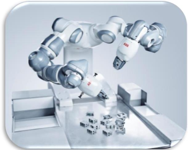
*Ilustración 16: Robot colaborativo YuMi de ABB*
