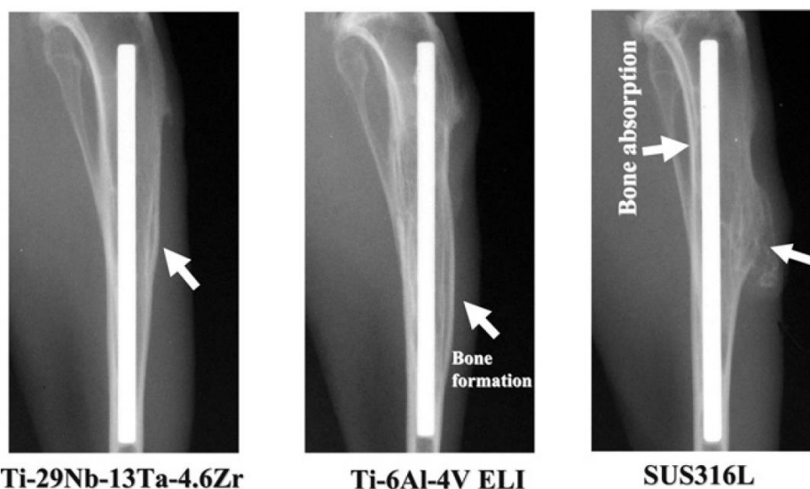
Figura 9. Remodelación ósea en función del módulo elástico del implante. Fuente: Niinomi, 2008 "Mechanical biocompatibilities of titanium alloys for biomedical applications".
