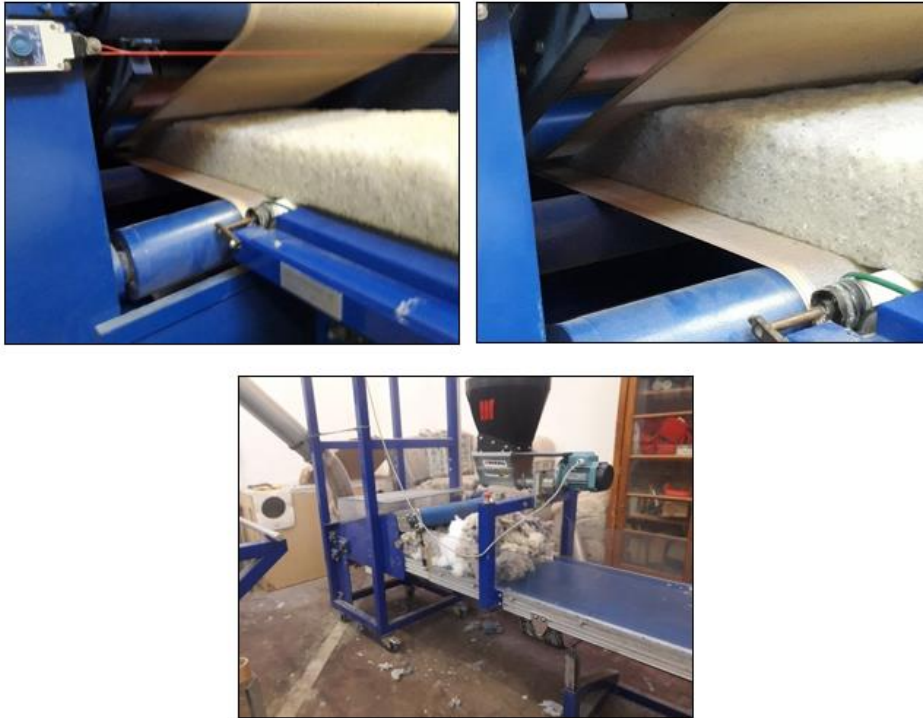
Ilustración 13 - Formación de una muestra no tejida mediante airlaid. Fuente: Elaboración propia.
