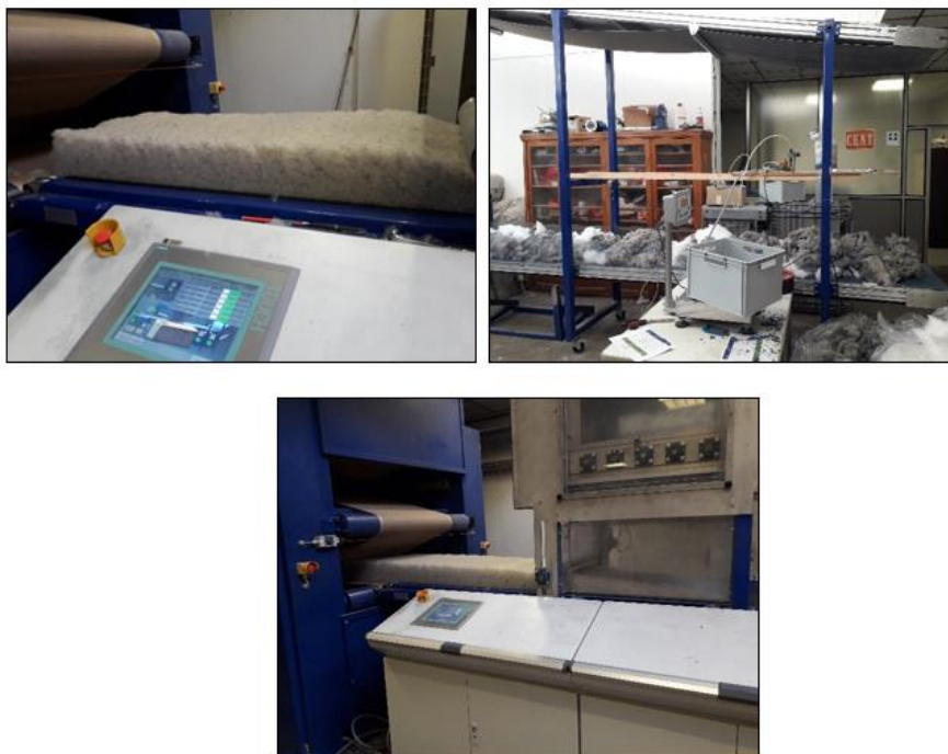
Ilustración 12 - Formación de la muestra no tejida airlaid 1. Fuente: Elaboración propia.
