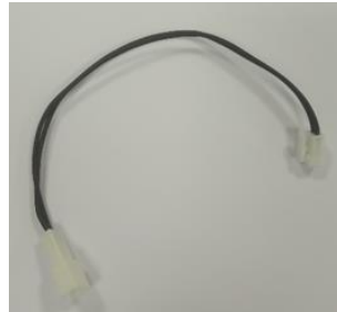
Figura 8: Cables extensores de la batería del robot bioloid
