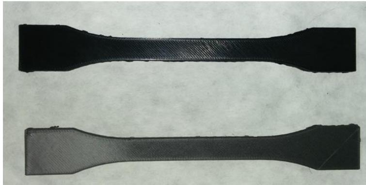
Fig. 75. Probetas impresas de polímero funcionalizado con el 5% de Carbon Black (arriba) y GNP's (abajo).
