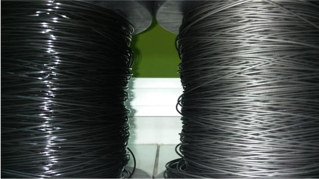
*Fig. 66. Filamentos de PLA con Carbon Black (izquierda) y PLA con Grafeno (derecha) al 5%.*
