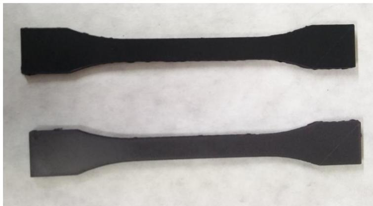
Fig. 76. Probetas impresas de polímero funcionalizado con el 10% de Carbon Black (arriba) y GNP's (abajo).
