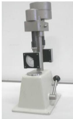
Fig. 79. Equipo empleado para los ensayos de dureza Shore
