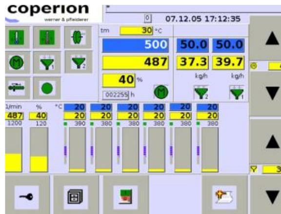
Fig. 42. PLC con el que se controla el equipo ZSK 18 MEGAlab.
