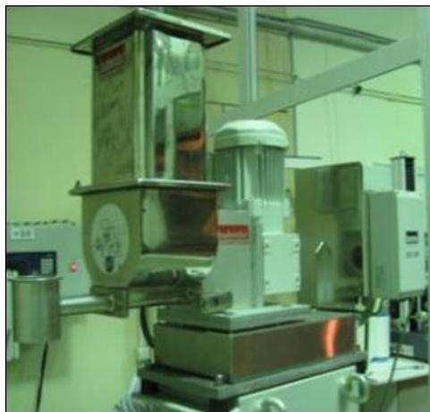
*Fig. 34. Dosificador gravimétrico.*
