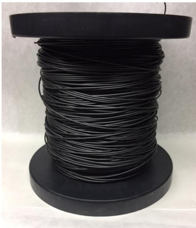
*Fig. 60. Monofilamento de PLA + 10% de GNP's.*
