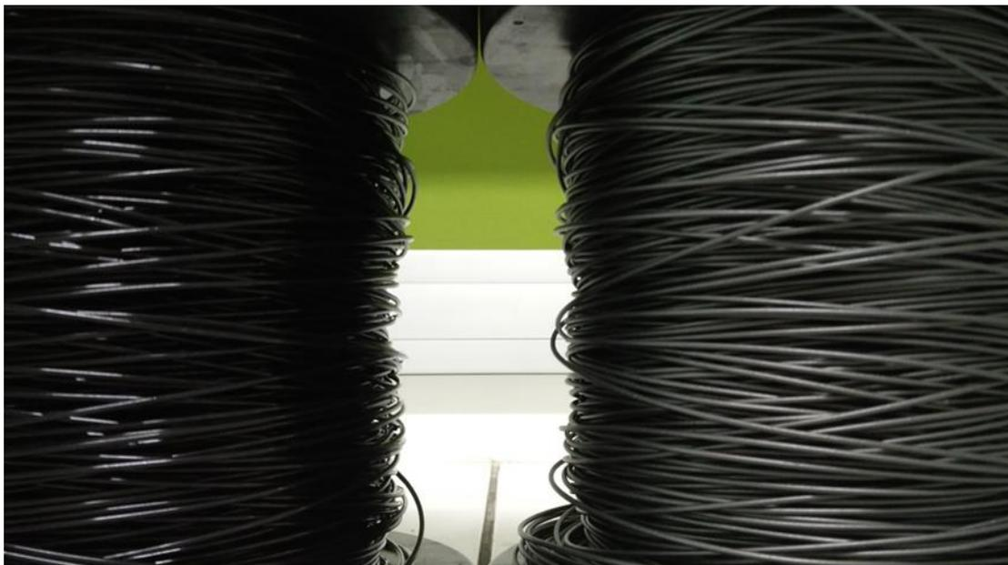
*Fig. 67. Filamentos de PLA con Carbon Black (izquierda) y PLA con Grafeno (derecha) al 10%.*
