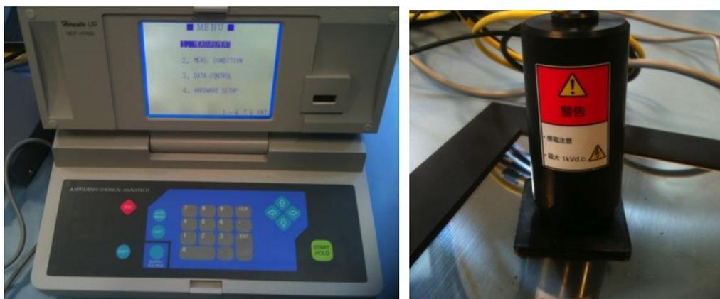
Fig. 77. Equipo de caracterización eléctrica Hiresta-UP MCP-HT450 y sonda URS MCP-HTP14
