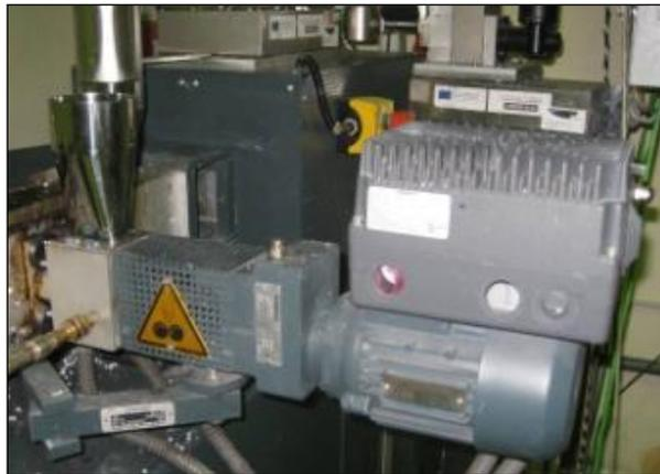
Fig. 43. Sistema de alimentación lateral.
