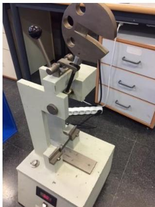
Fig. 80. Equipo utilizado en los ensayos de impacto
