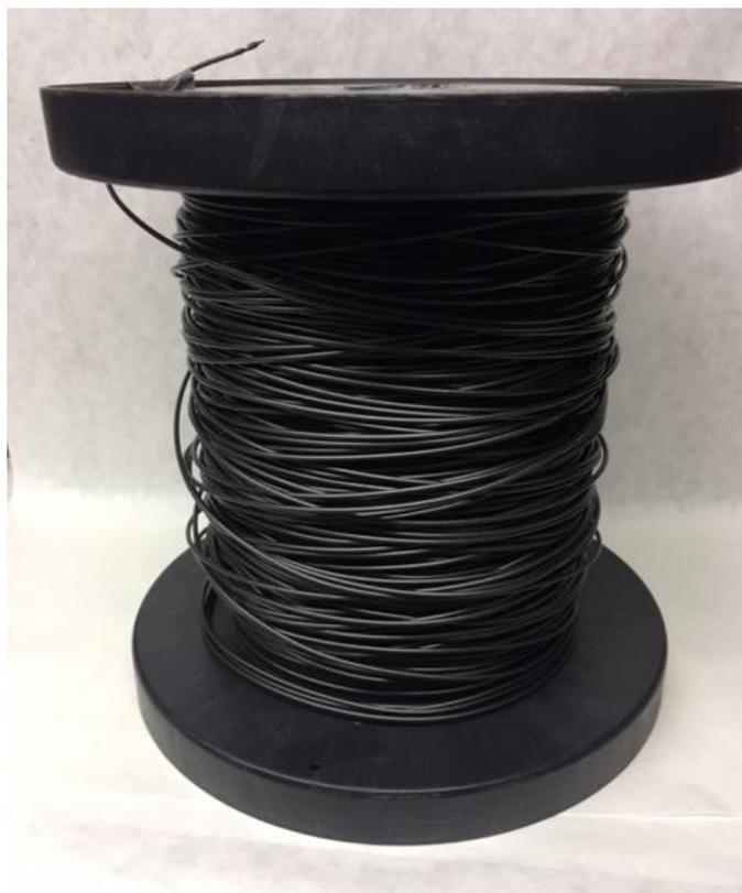
*Fig. 61. Monofilamento de PLA + 5% GNP's.*
