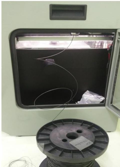
*Fig. 70. Disposición del carrete y sistema de alimentación de filamento.*
