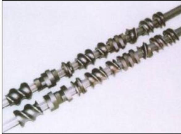
Fig. 41. Ensamblaje de los diferentes elementos del husillo en su eje.
