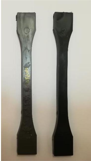
Fig. 65. Probetas de tracción inyectadas.
