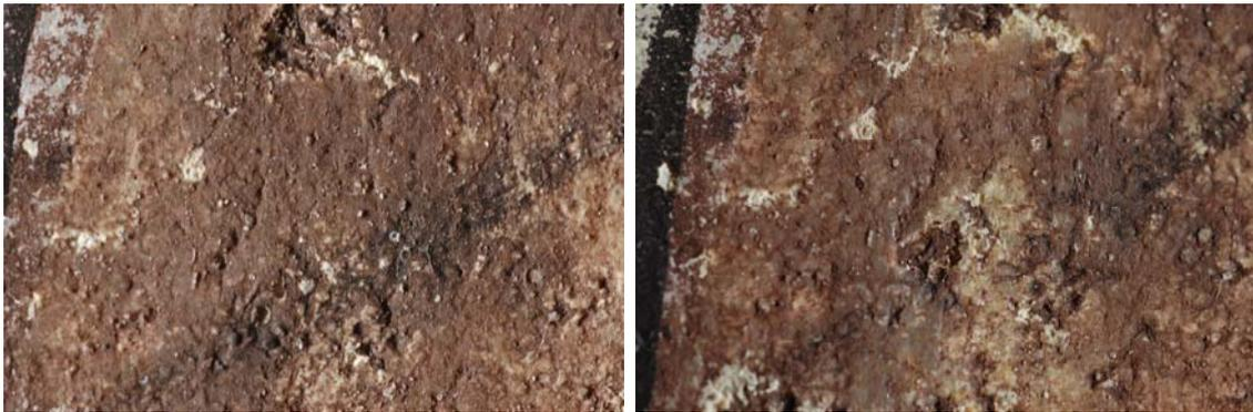
Probeta. 6-2. Antes y después de la abrasión
