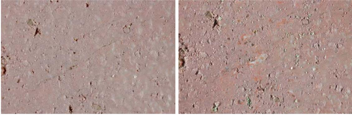
Probeta. 39-1. Antes y después de la abrasión
