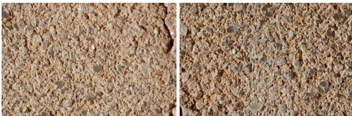
Probeta. 5-3. Antes y después de la abrasión
