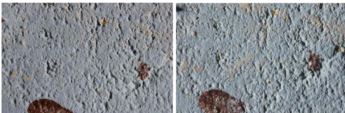
Probeta. 9-4. Antes y después de la abrasión
