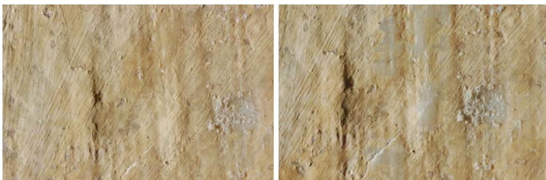
Probeta. 37-2. Antes y después de la abrasión
