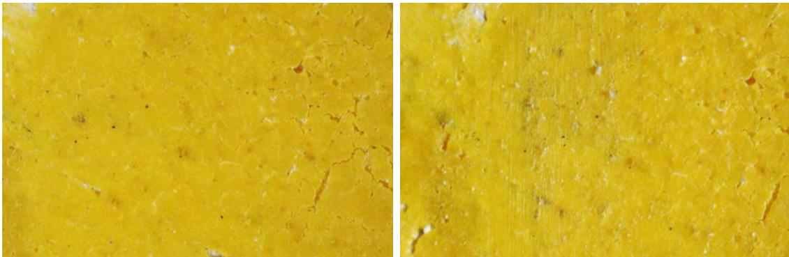
Probeta. 8-4. Antes y después de la abrasión
