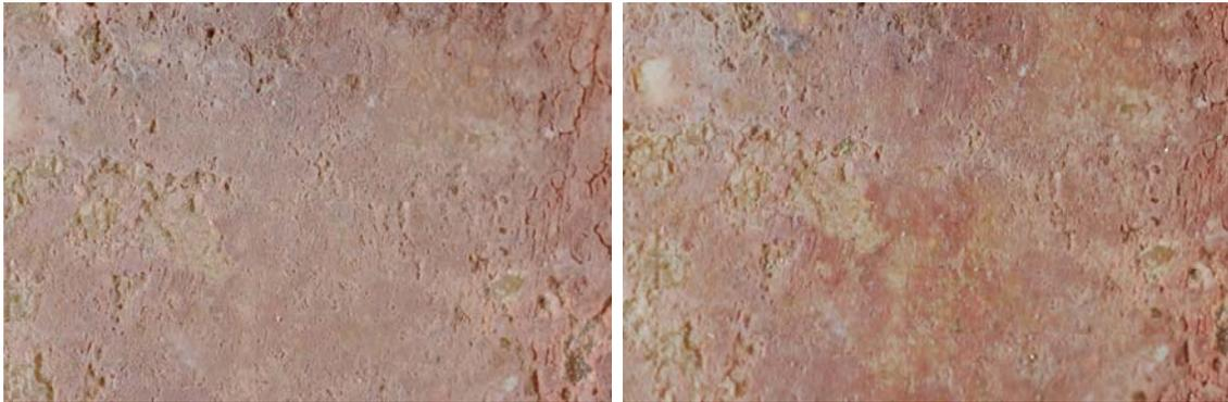
Probeta. 34-2. Antes y después de la abrasión
