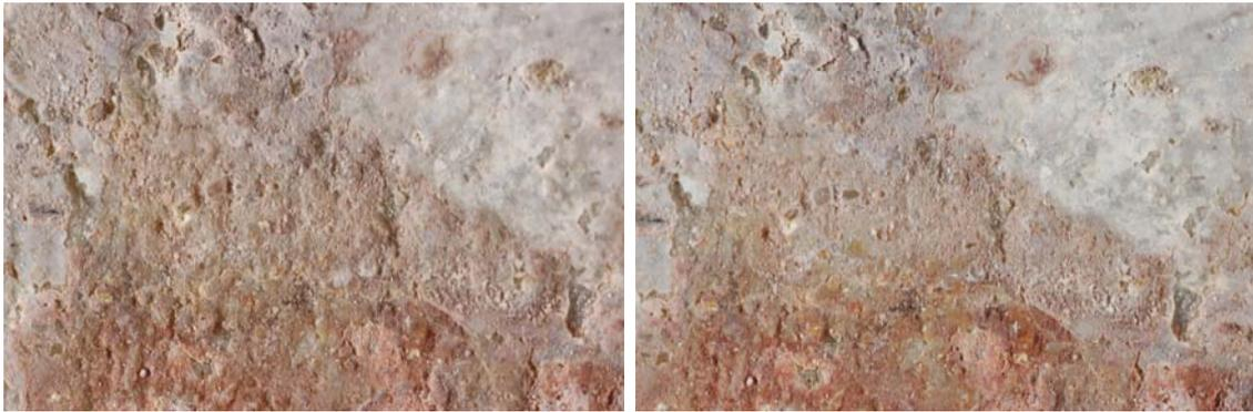
Probeta. 34-1. Antes y después de la abrasión
