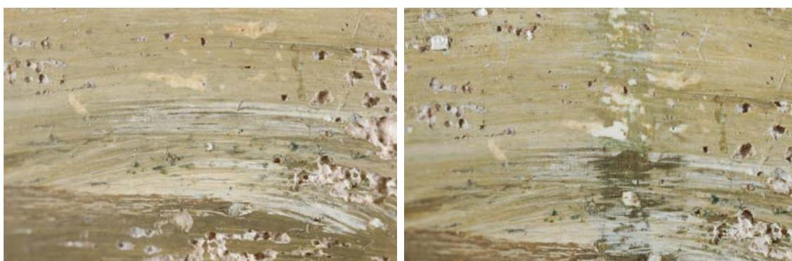
Probeta. 17-4. Antes y después de la abrasión
