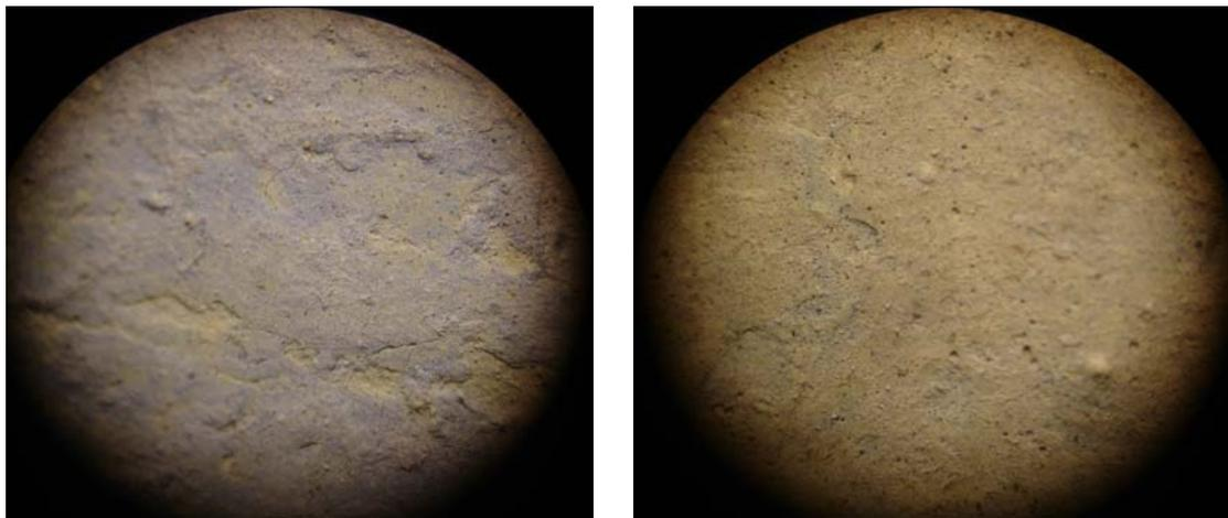
Fig.29. Fotografías con microscopio (2x). La pintura se mantiene estable con las resinas.
