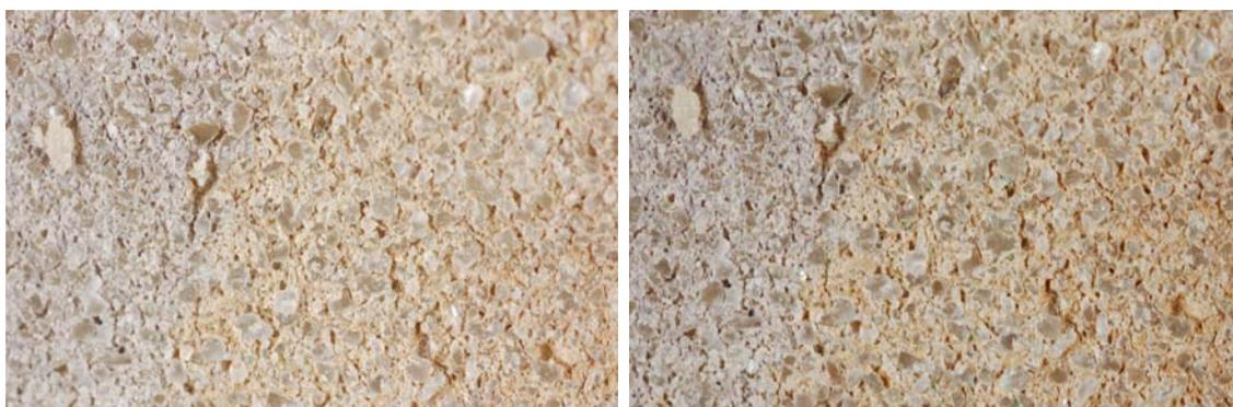
Probeta. 5-2. Antes y después de la abrasión
