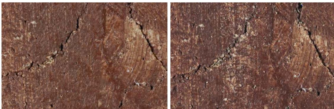
Probeta. 9-2. Antes y después de la abrasión
