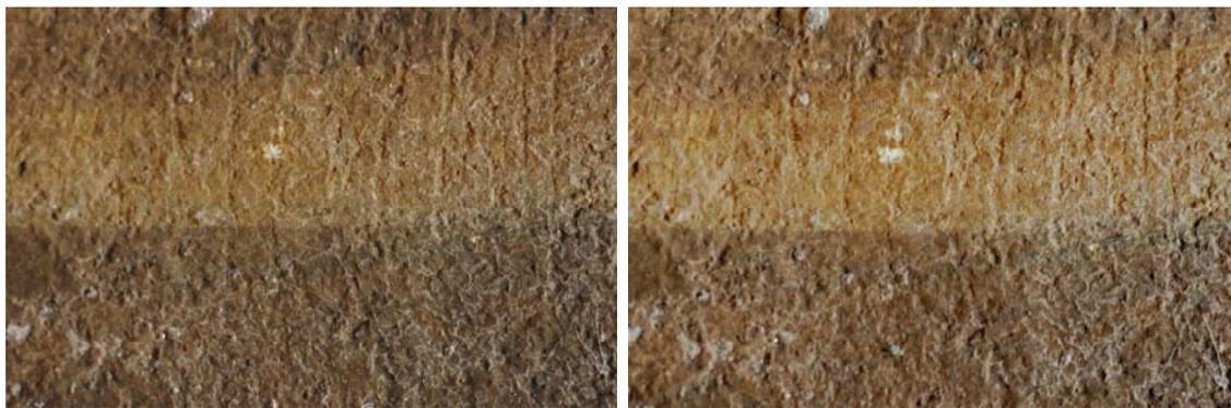
Probeta. 7-1. Antes y después de la abrasión
