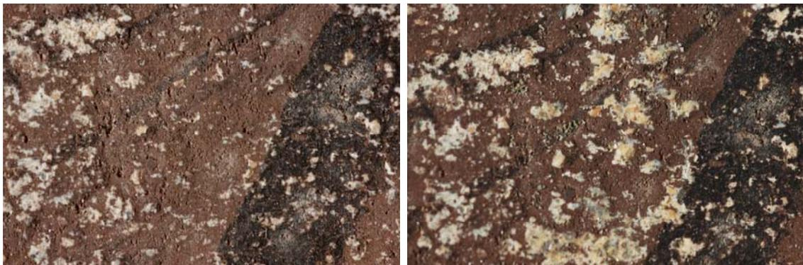
Fig. 19. Medición 6-3. Antes y después de la abrasión.
