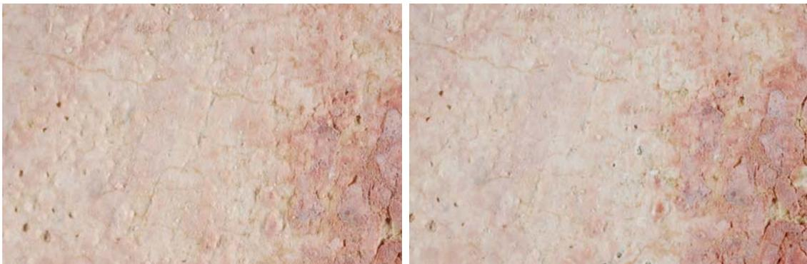
Probeta. 34-4. Antes y después de la abrasión
