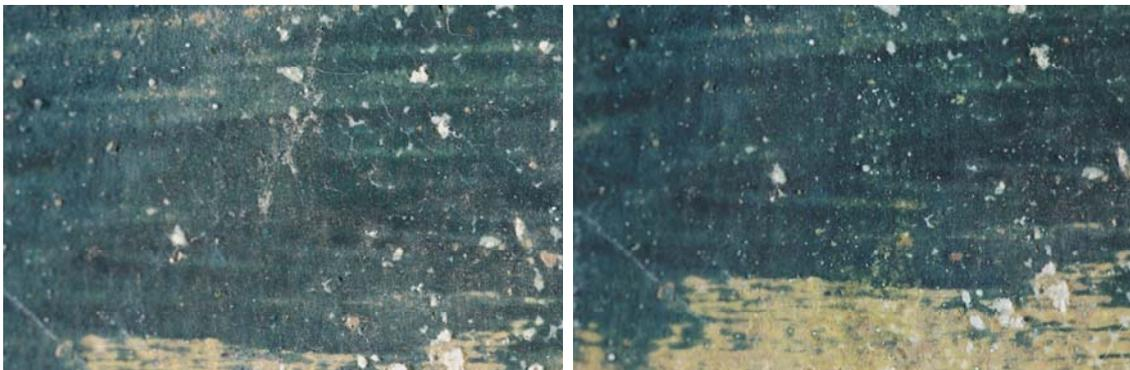
Probeta. 60-4. Antes y después de la abrasión
