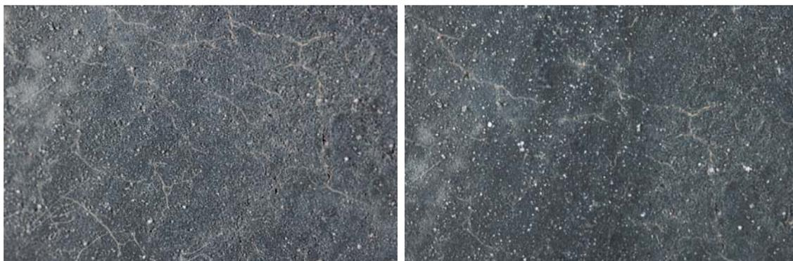
Probeta. 40-1. Antes y después de la abrasión
