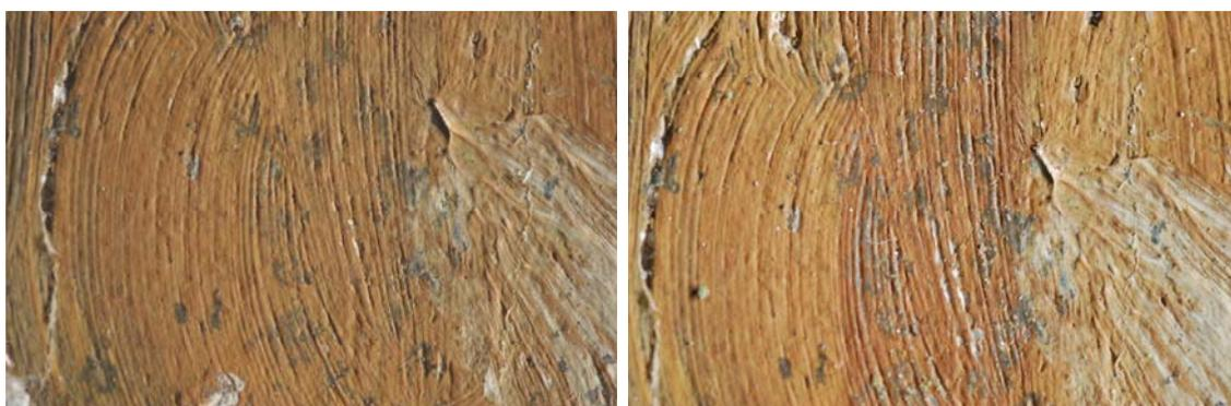
Probeta. 17-3. Antes y después de la abrasión
