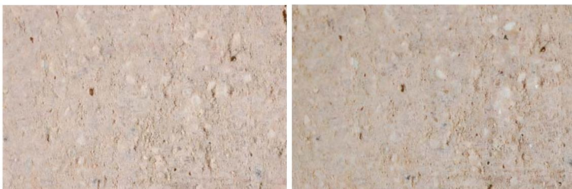
Probeta. 25-4. Antes y después de la abrasión
