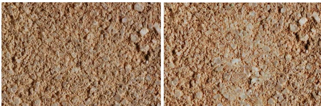
Probeta. 5-4. Antes y después de la abrasión
