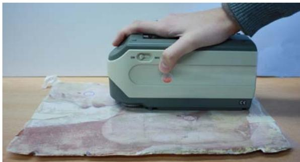
Fig. 17. Utilizando el espectrofotómetro Minolta CM-2600d
