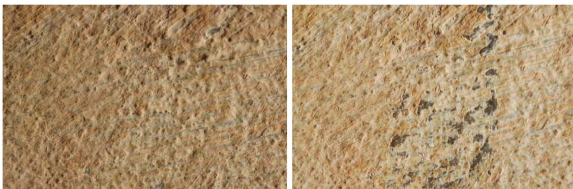
Probeta. 49-2. Antes y después de la abrasión
