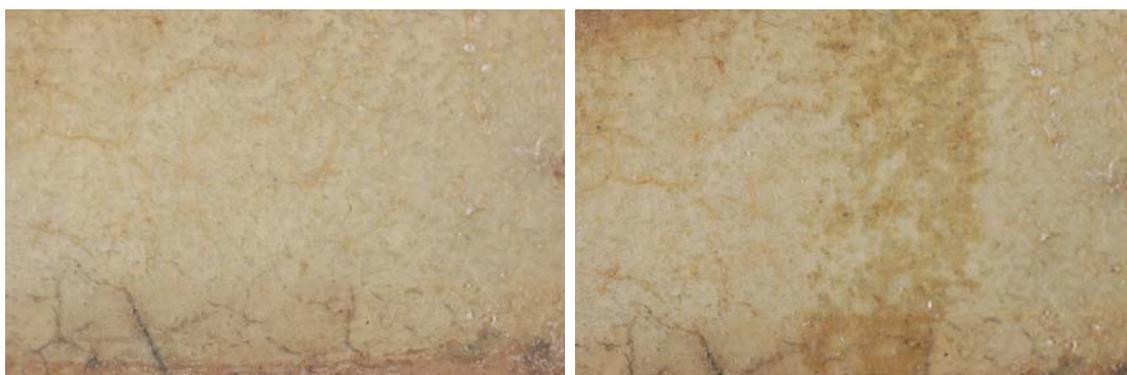
Probeta. 49-1. Antes y después de la abrasión
