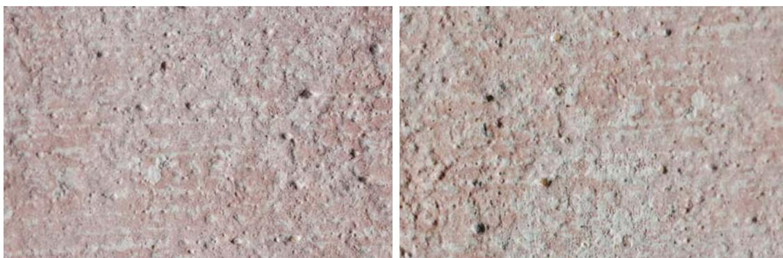
Probeta. 4-3. Antes y después de la abrasión
