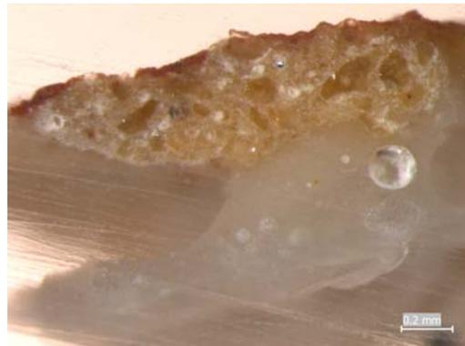
Fig. 9. Muestra 24-3 (probeta N° 24) de la resina EPO150 + carbonato cálcico. x40
