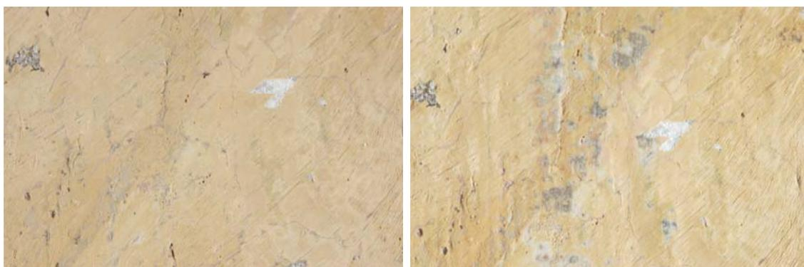
Probeta. 37-1. Antes y después de la abrasión
