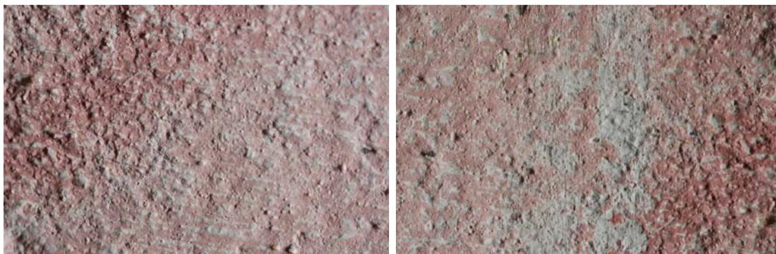
Probeta. 4-1. Antes y después de la abrasión
