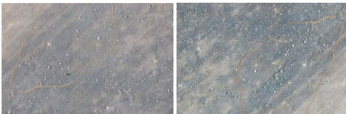
Probeta. 40-4. Antes y después de la abrasión
