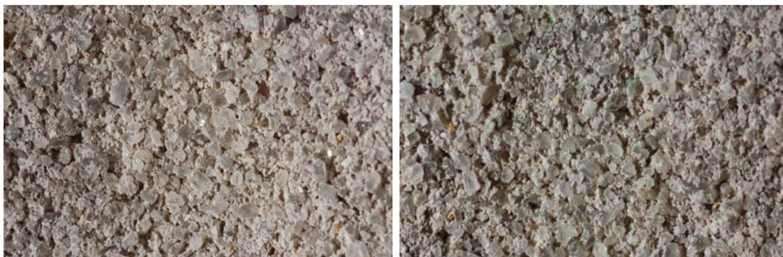
Probeta. 5-1. Antes y después de la abrasión
