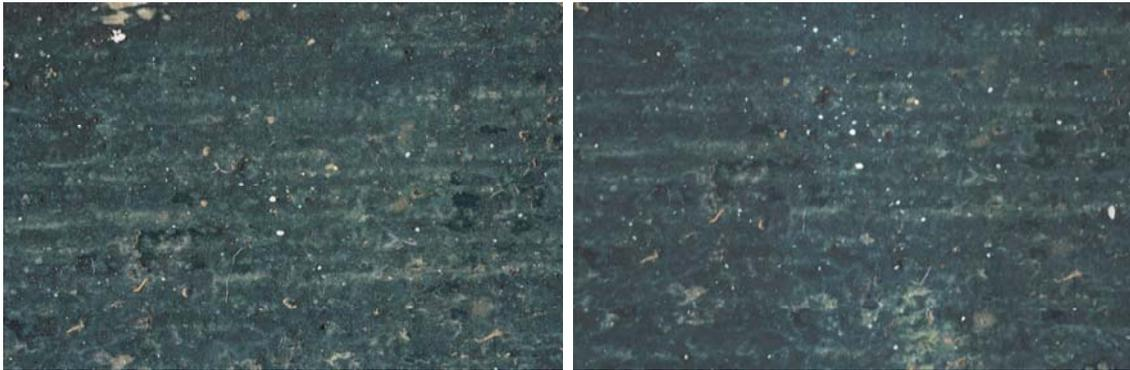
Probeta. 60-2. Antes y después de la abrasión
