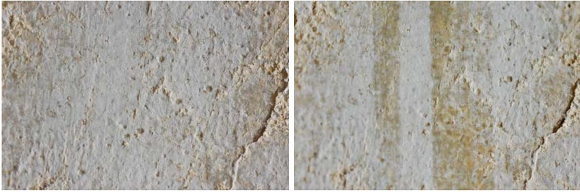
Probeta. 6-1. Antes y después de la abrasión
