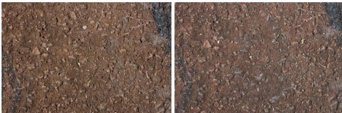
Probeta. 36-1. Antes y después de la abrasión
