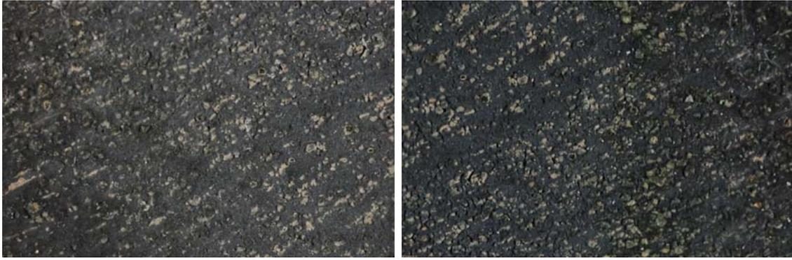
Probeta. 29-1. Antes y después de la abrasión
