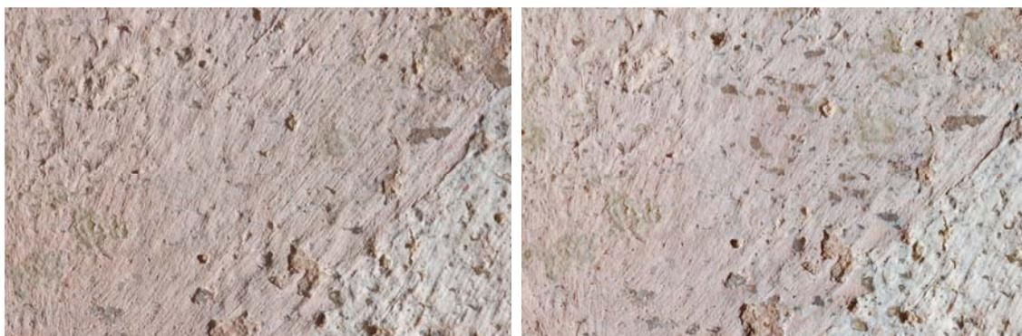
Probeta. 24-2. Antes y después de la abrasión
