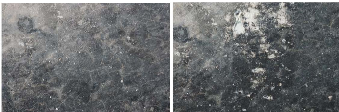
Probeta. 40-3. Antes y después de la abrasión
