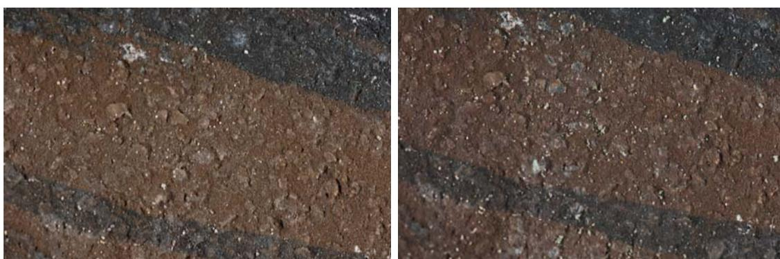
Probeta. 36-4. Antes y después de la abrasión
