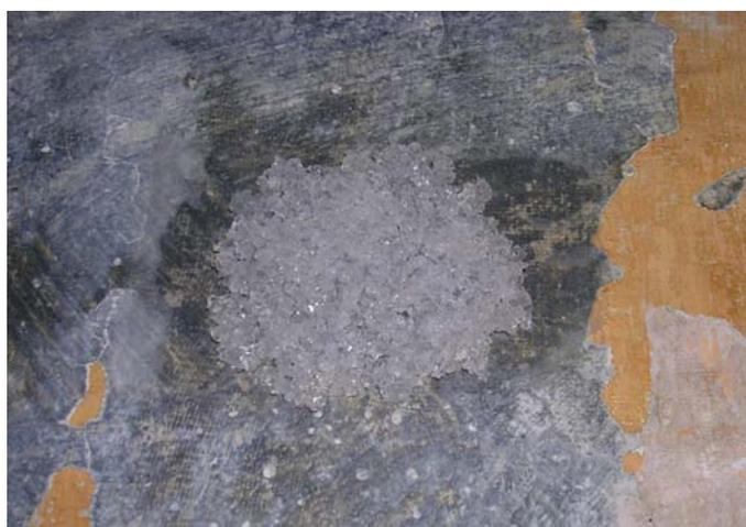
Fig. 37. Pruebas de limpieza con solvent gel
