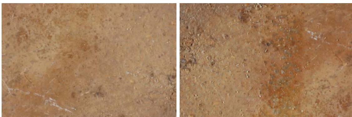
Probeta. 49-3. Antes y después de la abrasión
