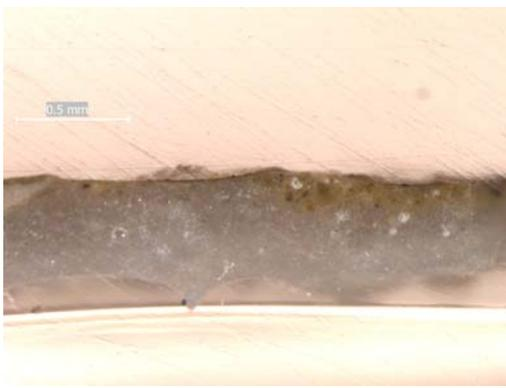
Fig. 12. Muestra 49-4 (probeta N° 49) de la resina EPO150+ cuarcita superventilada. x32
