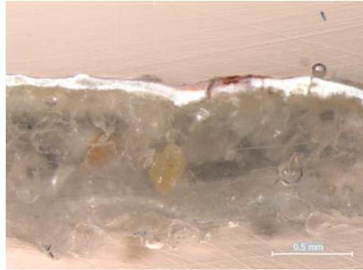
Fig. 5. Muestra 4-2 (probeta N° 4) de la resina EPOMIX + cuarcita. x32
