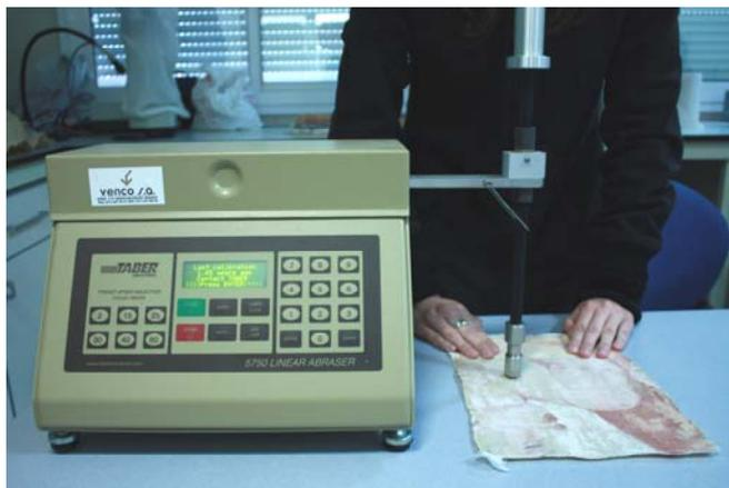
Fig. 18. Utilizando el abrasímetro lineal
