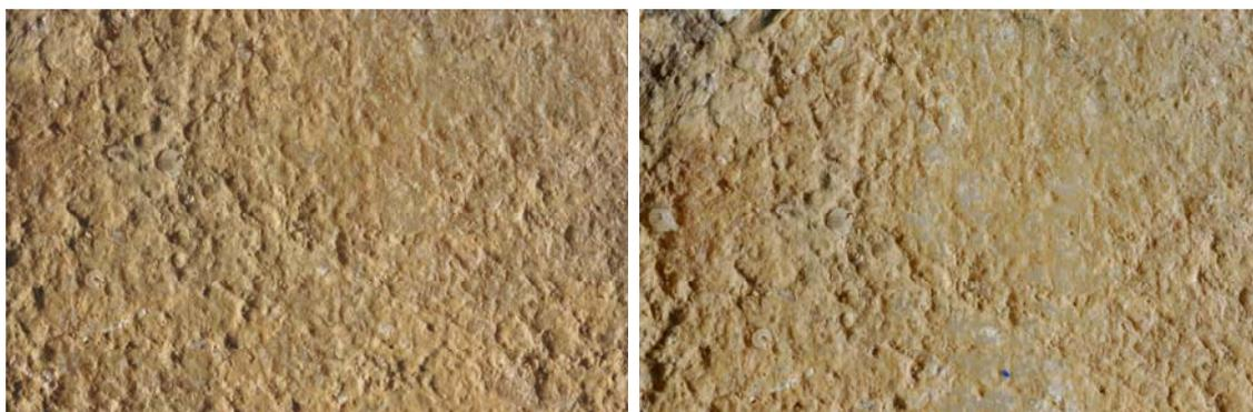
Probeta. 7-2. Antes y después de la abrasión
