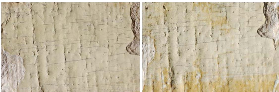
Probeta. 37-4. Antes y después de la abrasión
