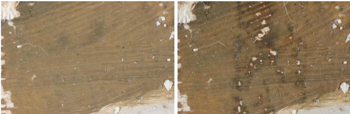
Probeta. 27-4. Antes y después de la abrasión
