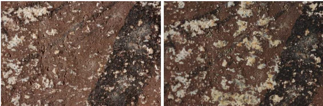
Probeta. 6-3. Antes y después de la abrasión
