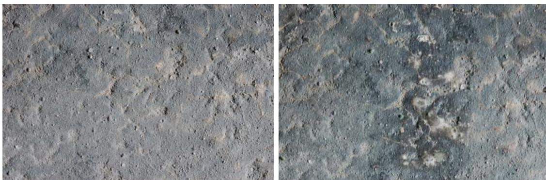
Probeta. 40-2. Antes y después de la abrasión
