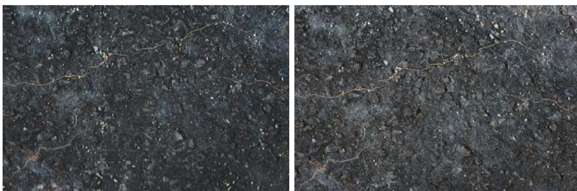
Probeta. 36-3. Antes y después de la abrasión
