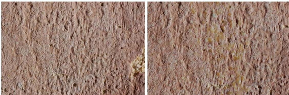
Probeta. 24-4. Antes y después de la abrasión
