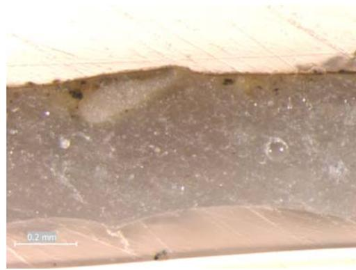
Fig. 13. Muestra 49-4 (probeta N° 49) de la resina EPO150+ cuarcita superventilada. x63
