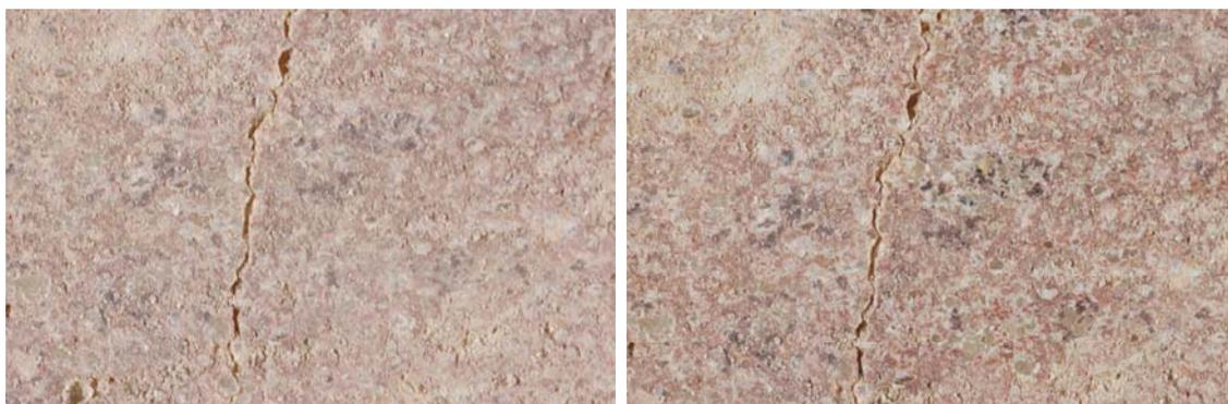
Probeta. 25-2. Antes y después de la abrasión
