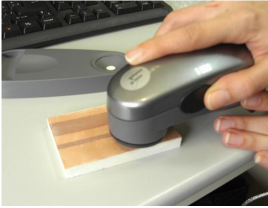
Fig. 59: Momento de toma de mediciones en una de las probetas utilizando el espectrofotómetro Eye One modelo X-Write
