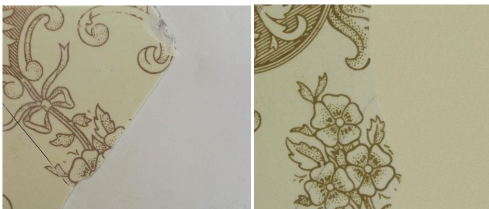
Figs. 2 y 3: ejemplos de estuco a bajo nivel y estuco pigmentado en dos fragmentos de azulejo
