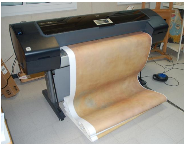
Fig. 31: Imagen de la HP DESING-JET Z3100 Photo en pleno proceso de impresión de uno de los lienzos con los que se iban a restituir los faltantes de las pinturas de la bóveda del Teatro Leal.
