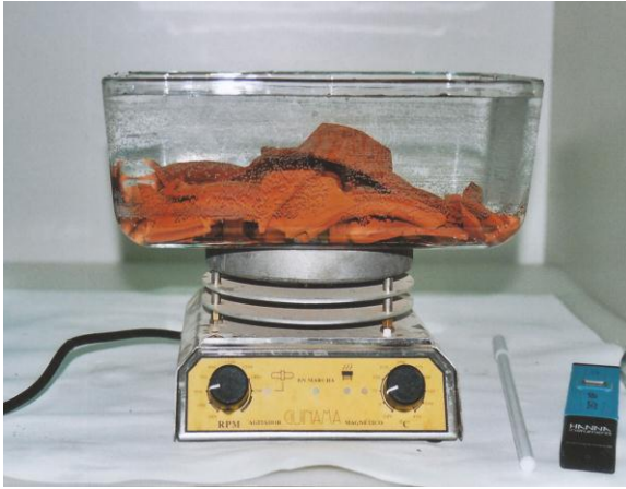
Fig. 99: Los fragmentos en el agitador magnético
