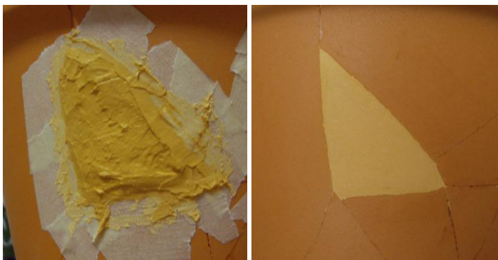
Fig. 18 y 19: Ejemplo de utilización de un estuco pigmentado. Aunque en húmedo el estuco tiene un color bastante intenso (fig. 18), una vez seco el tono varía y se aclara notablemente (fig. 19).
