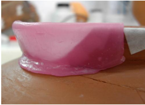
Fig. 115 (arriba): detalle de contraforma con cera dental en la base.
