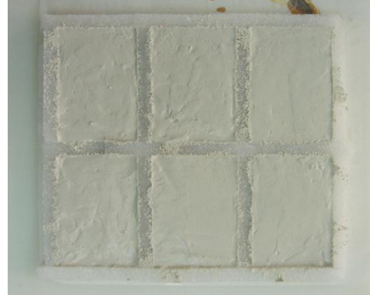
Fig. 38: Las probetas durante su fraguado
