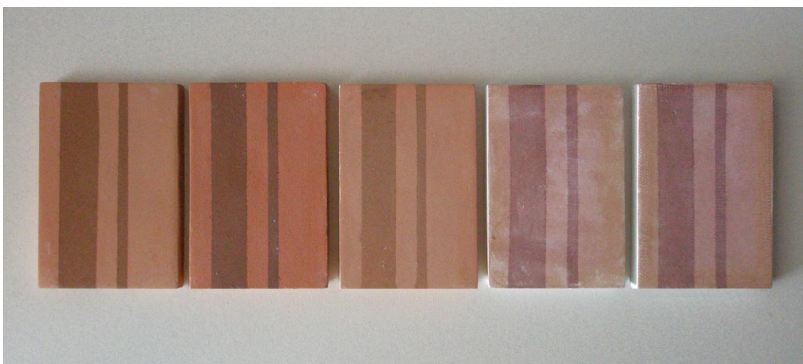
Fig. 58: Las probetas sometidas a envejecimiento acelerado en cámara UV. De izquierda a derecha: pintura acrílica, gouache barnizado, gouache sin barnizar, transferencia sobre probeta cruda y transferencia sobre probeta imprimada con Acril. El deterioro de las tintas es más irregular y más notable por zonas en la transferencia de la probeta no protegida.
