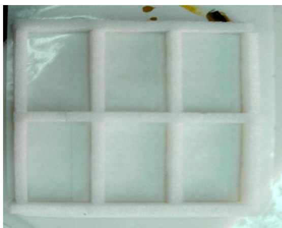
Fig. 35: Molde de Etafoam ® para las probetas
