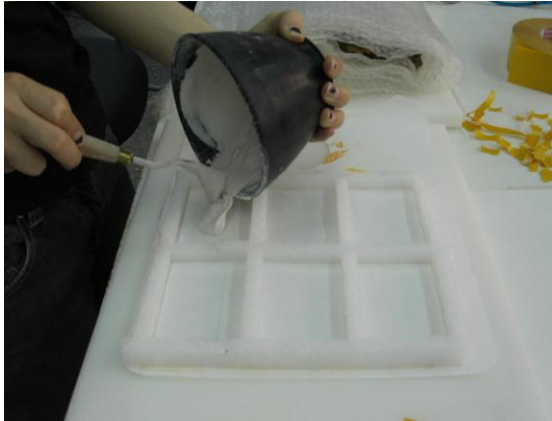
Fig. 37: Vertido del estuco en los moldes
