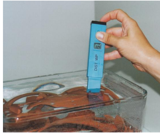
Fig. 100: Medición de sales presentes en el agua
