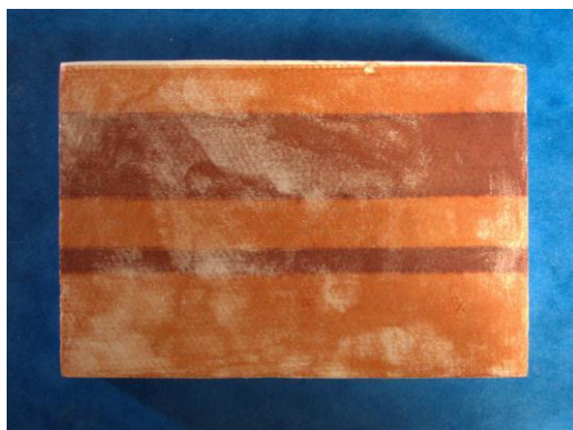
Fig. 52: Probeta con doble aplicación de transferencias.
