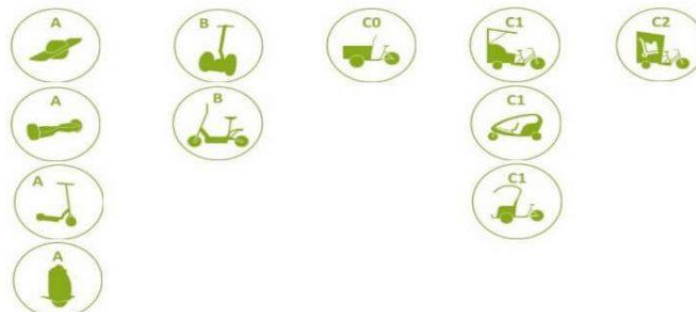
Fig. 5. Clasificación de los vehículos de movilidad urbana o personal según la instrucción 16/V-124 de la Dirección General de Tráfico.
