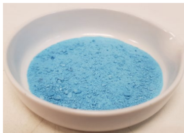
Figura 5.3.4. Imagen del catalizador basado en alúmina sintetizada a 600 °C y calcinado a 800 °C después de incorporar el Ni (20NiAlu_6_8).
