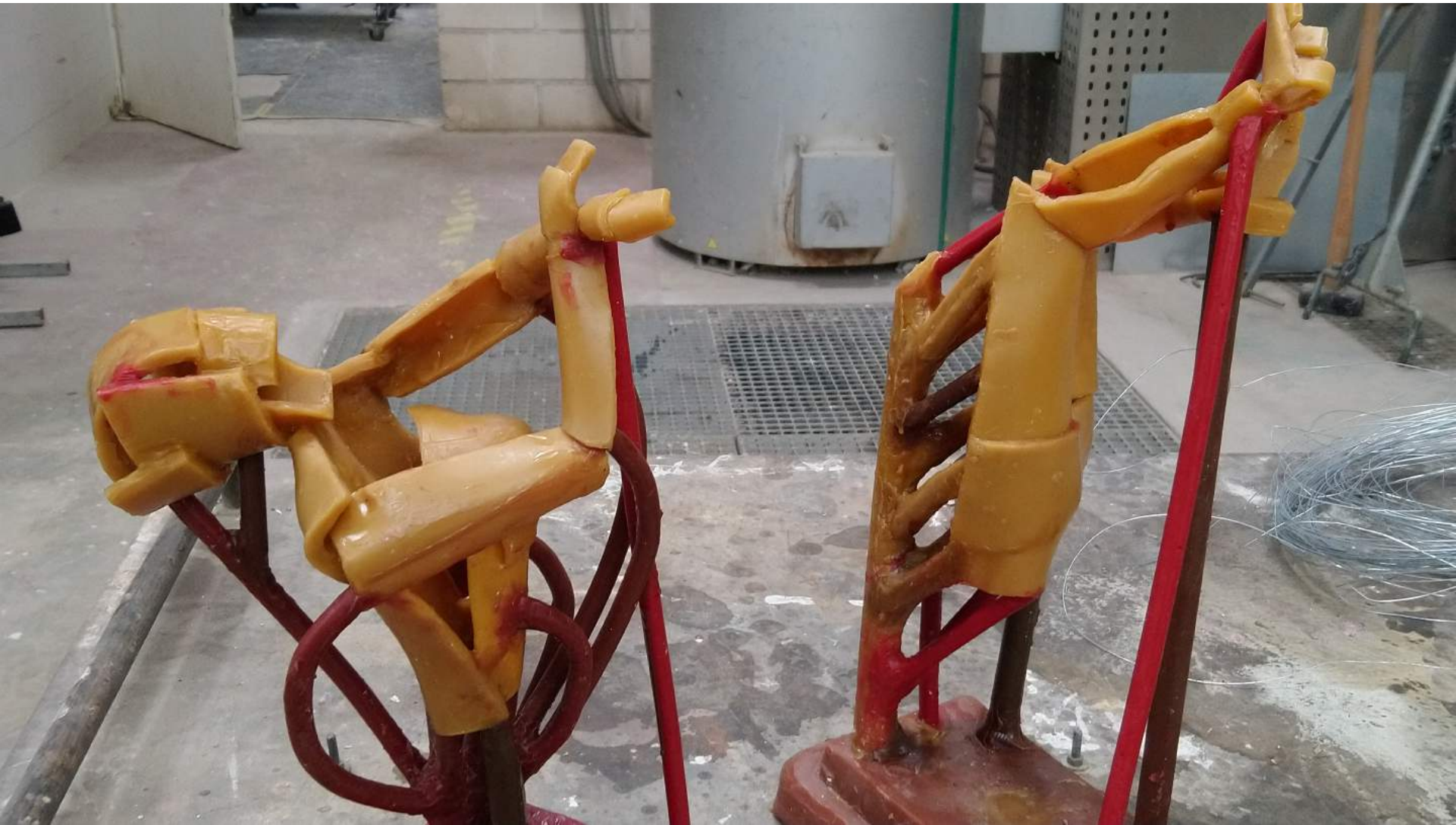
Despiece y estructura de copas y bebederos
